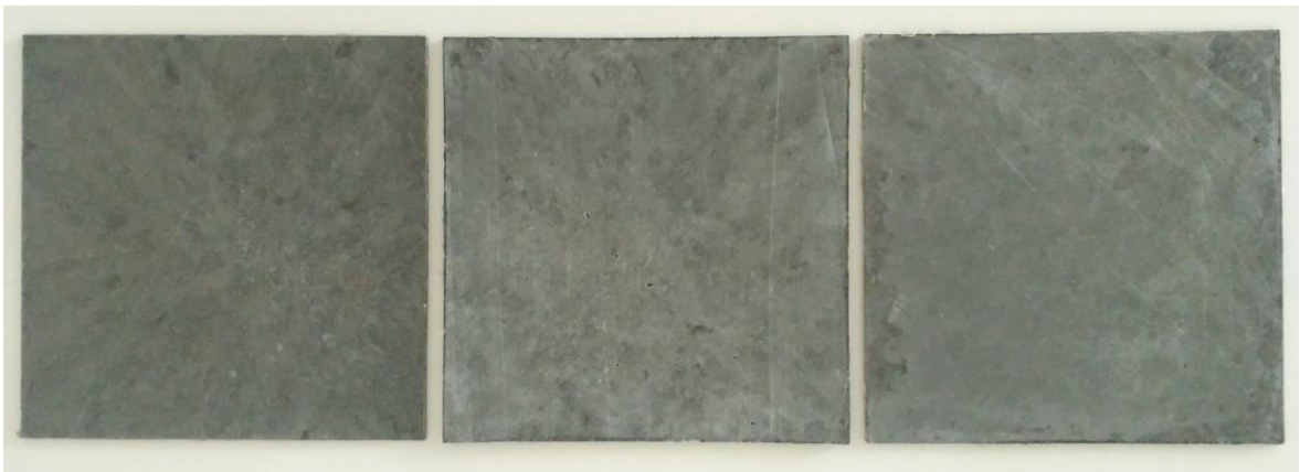
Obrázek 52 – Odpadní PP obsahující skelná vlákna s odpadním tetrapakem [52]
