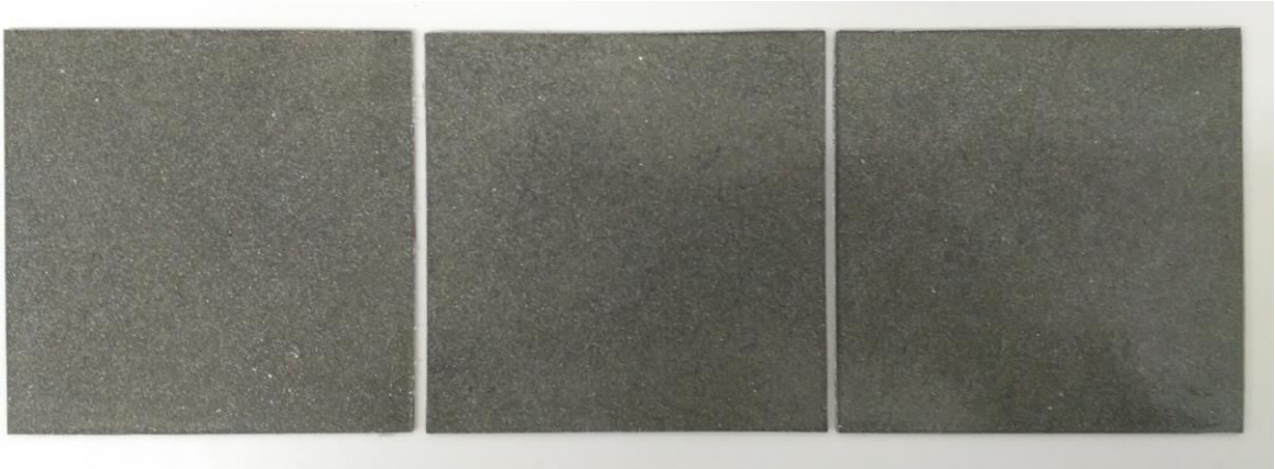
Obrázek 51 – Upravený PE Dowlex s odpadním tetrapakem [52]
