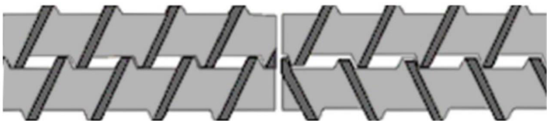
Obrázek 28 – Uspořádání šneků, stejnoběžné (vlevo), protiběžné (vpravo) [38]
