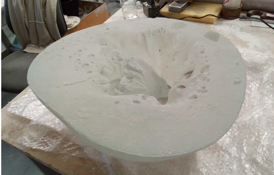
Obrázek 39 Stolec Eroze po pískování
