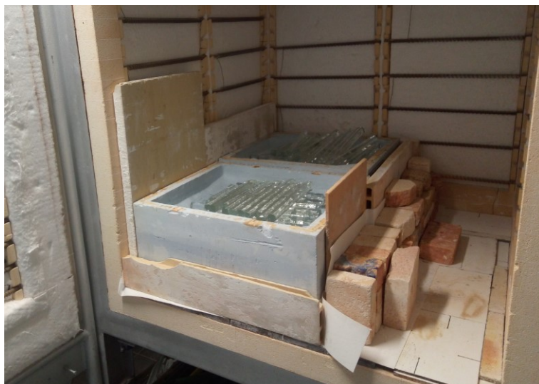
Obrázek 35 Nakládání do pece
