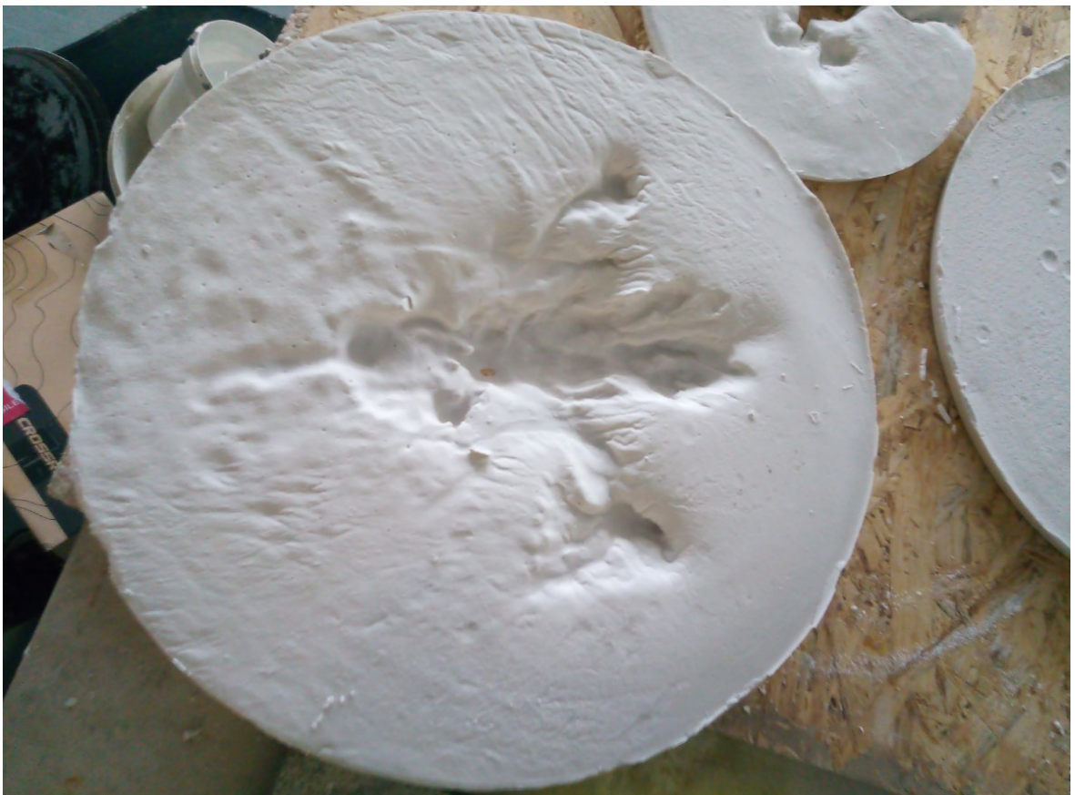
Obrázek 21 Působení vody na směs sádry a písku
