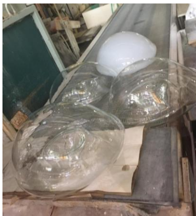
Obrázek 34 Vychlazené kusy připravené na opuknutí
