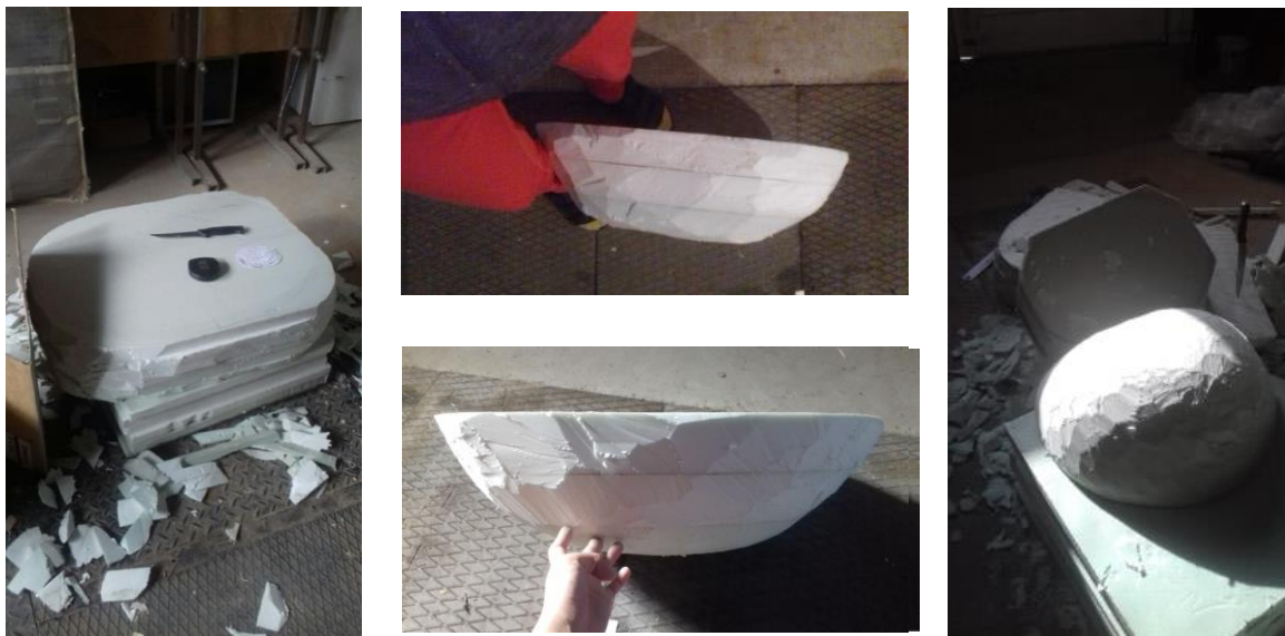
Obrázek 21 Proces výroby modelů 1:1
