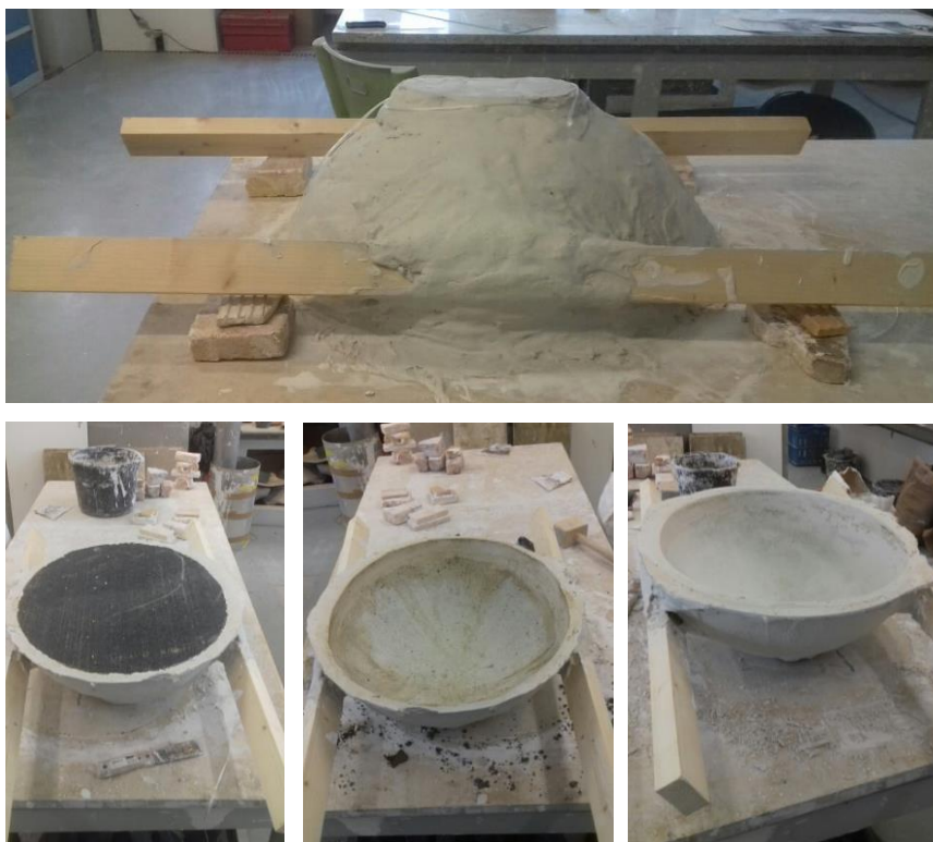
Obrázek 32 Výroby sádrové formy
