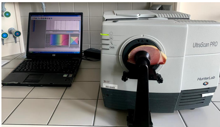
Obr.21 Měření barvy na kolorimetru na ústavu materiálového inženýrství na budově U15
