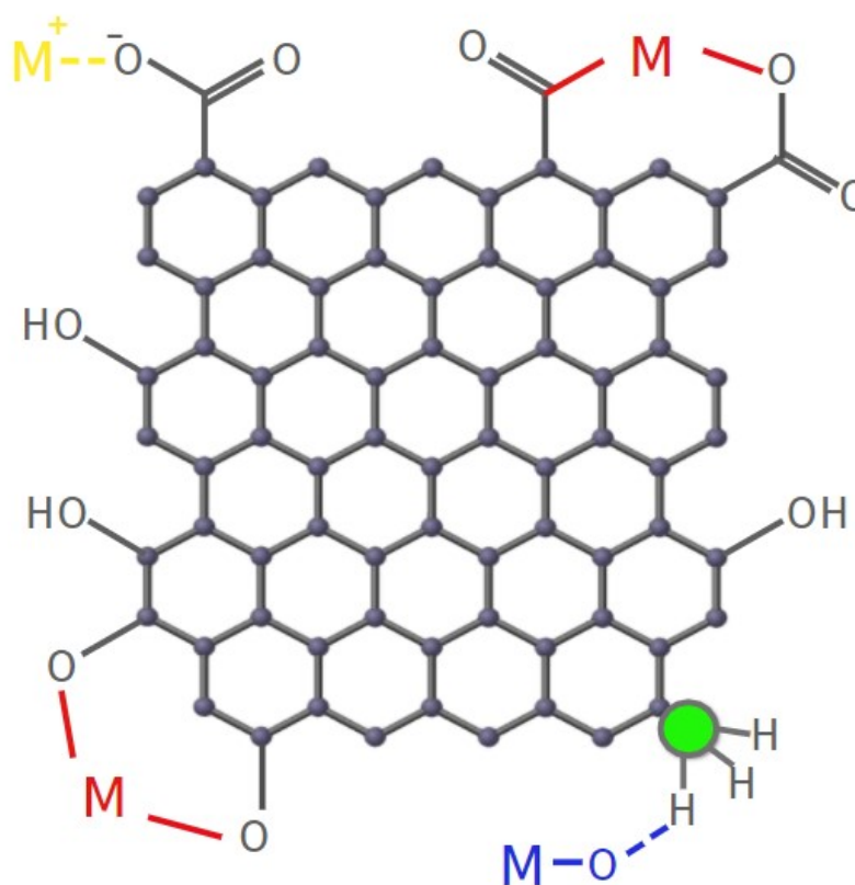
Obrázek 4: Schématické znázornění možných interakcí kovů a grafen oxidu [28]
