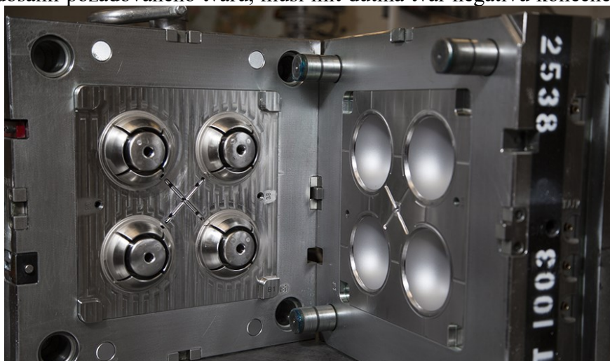
Obrázek 4 Dutina vstřikovací formy s násobností 4 [20]
