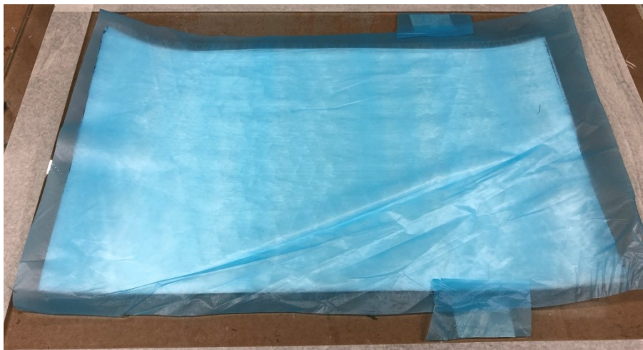
Obr. 45 Aplikace děrované separační fólie pod vrstvou odtrhové tkaniny pro lepší manipulaci při odtrhování a odstranění pomocných materiálů od výrobku
