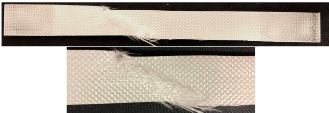
Obr. 52 Charakteristické porušení zkušebního tělíska kompozitu s tkaninou plátňové vazby (nahore); detailní pohled (dole)
