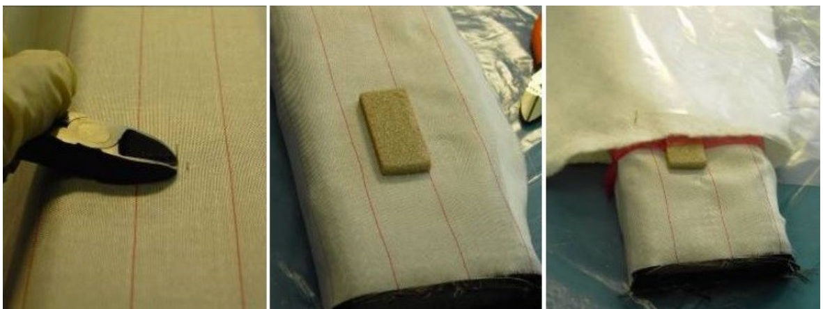
Obr. 24 Opatření pro ochranu kolíků vodičů; zkrácení vodičů na délku cca 2 mm (vlevo); aplikace ochranného pěnového krytu (uprostřed); aplikace dalších vrstev technologických materiálů; dle [24]
