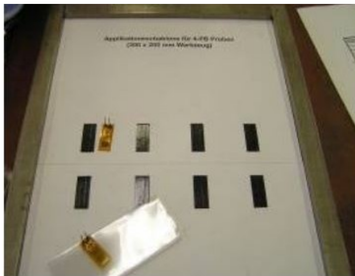
Obr. 21 Vyrovnání tenzometru do formy pomocí instalační šablony; dle [24]
