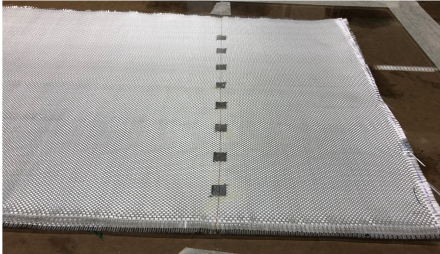
Obr. 44 Umístění insertů s příčným drátem mezi 3. a 4. vrstvou vyztužující skelné tkaniny s plátňovou vazbou
