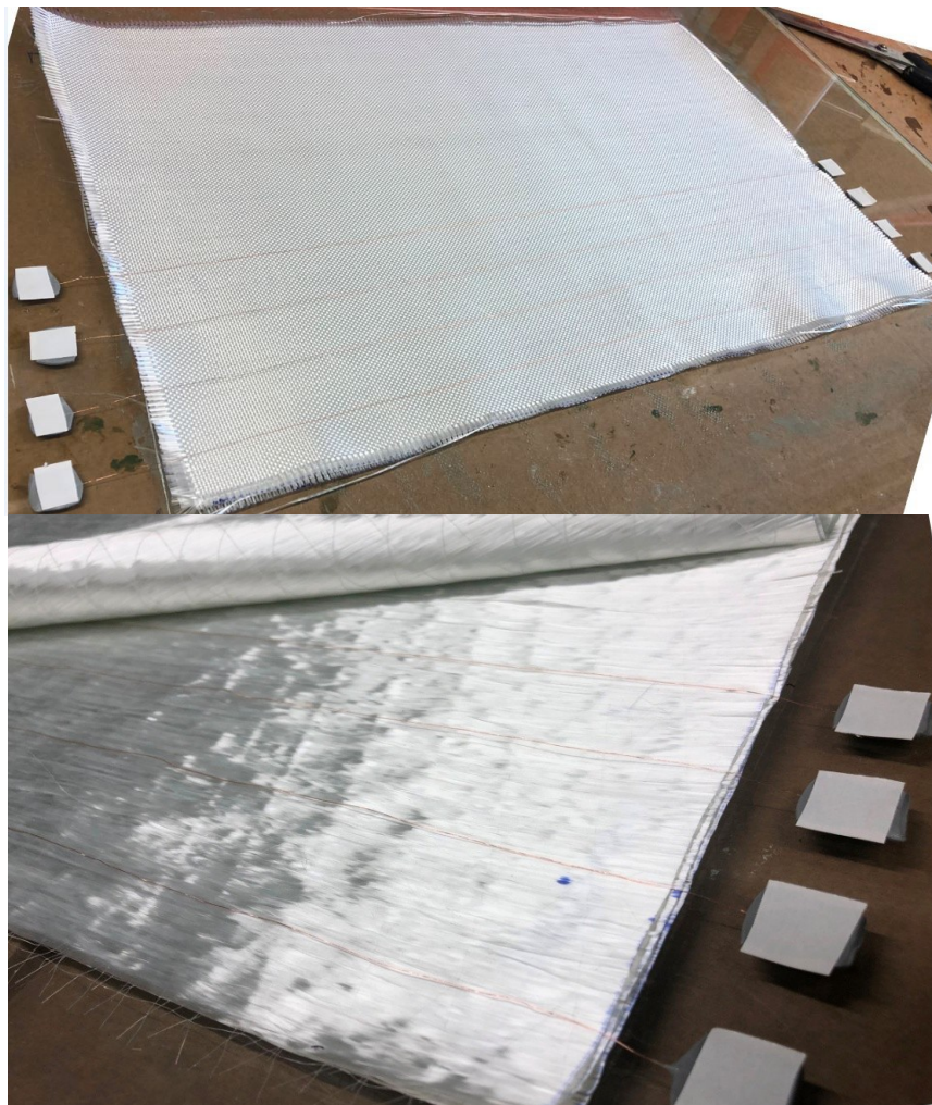
Obr. 36 Umístění podélných drátů mezi 3. a 4. vrstvou obou typů vyztužujících skelných tkanin
