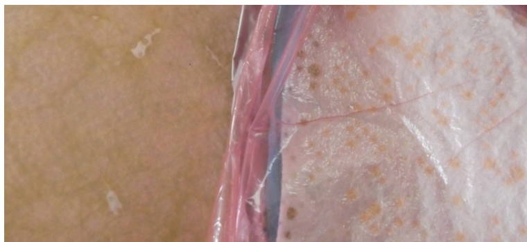
Obr. 61. Rozdílné smočení odsávací tkaniny v případě první optimalizace vytvrzovacího cyklu (vlevo) a cyklu provedeného dle výrobce prepregu (vpravo)
