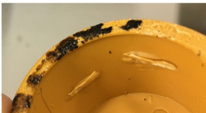
Obr. 30 Černé spálené usazeniny na součásti [17]
