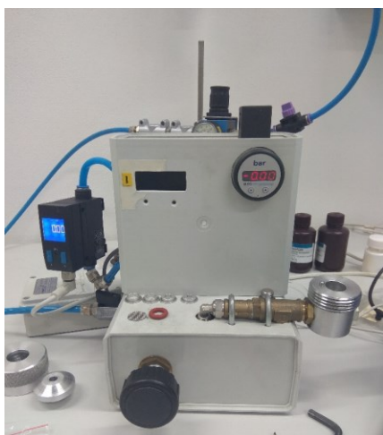
Obrázek 37: Přístroj pro stanovení prodyšnosti netkaných textilií
