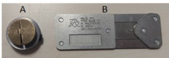
Obrázek 32: Speciální přípravky pro upnutí vláken a) pro SEM, b) pro optický mikroskop
