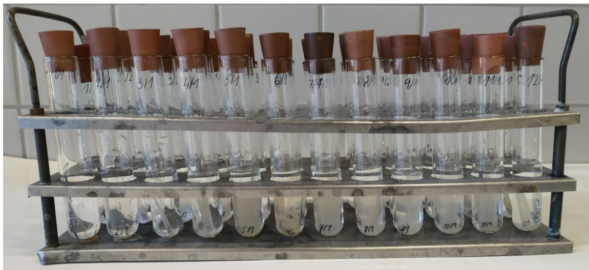
Obr. 45: Nasákavost: sestava pro měření
