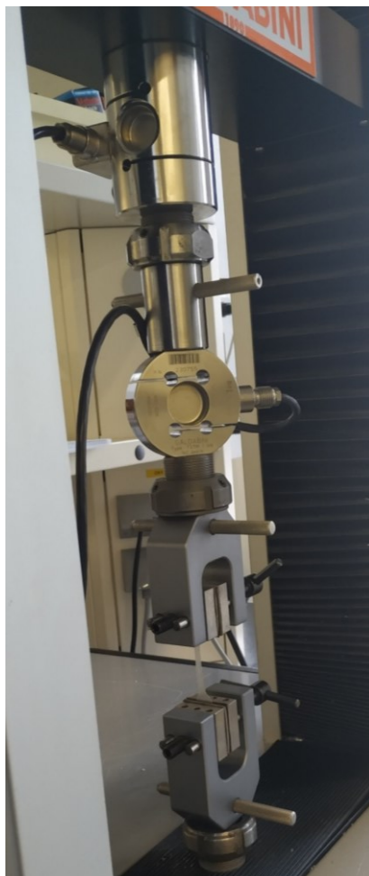
Obr. 50: Tahové zkoušky na laboratorním trhacím stroji Quasar 25
