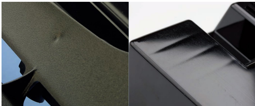
Obr. 35. Příklad propadlin na hotovém dílci [25]
