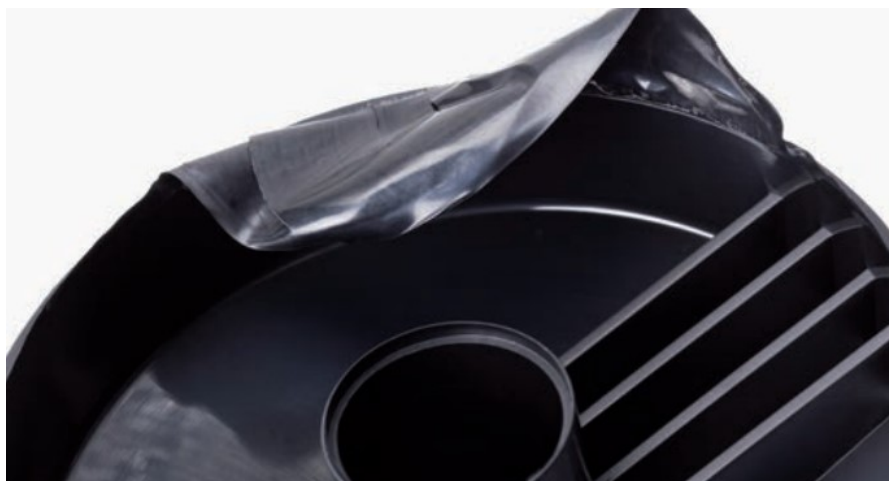
Obr. 33. Příklad přetečeného vstřikovaného dílu [25]
