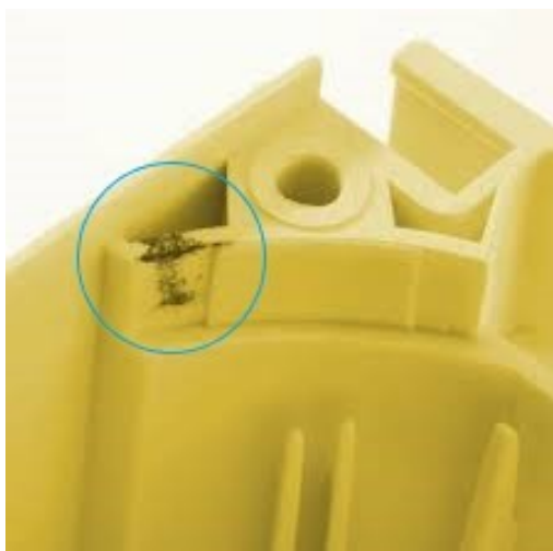
Obr. 32. Příklad diesel efektu [25]
