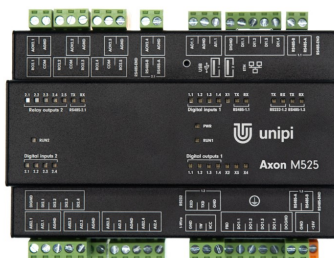
Obrázek 5.2 Programovatelný automat Unipi Axon M525[18]
