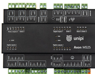
Obrázek 2.4 Programovatelný automat Unipi Axon M525[18]
