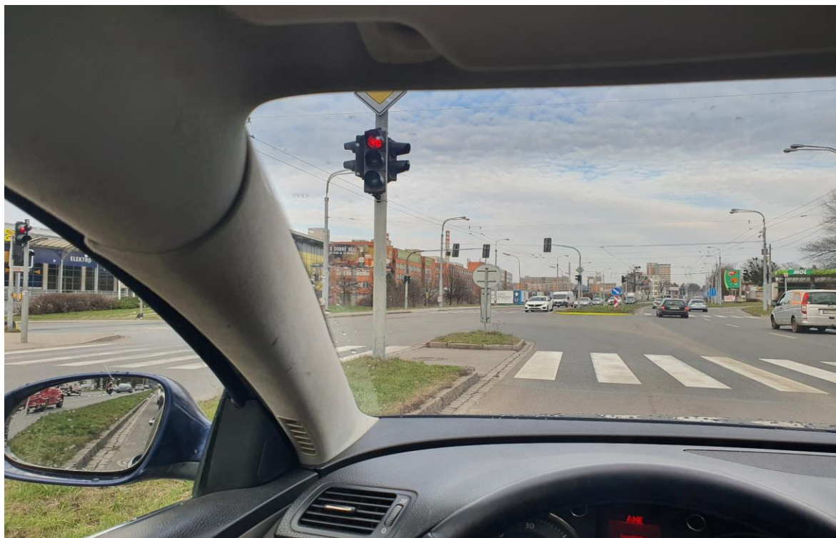
Obrázek 15 Zakrytý výhled z kabiny vozidla na výstražnou skříň PZS
