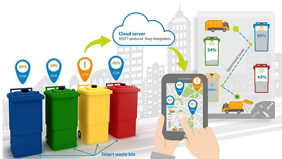
Obrázek 5 Chytrý systém odpadového hospodářství s využitím IoT (Medvedev, 2015)
