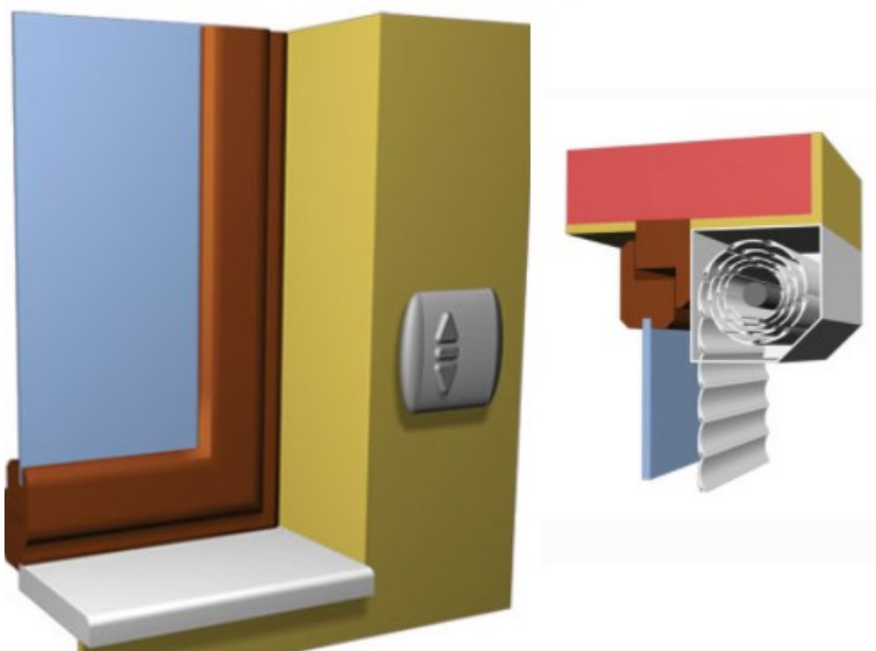
Obrázek 19: Montáž venkovních žaluzií na rám okna s ovládáním (Almma, 2020)
