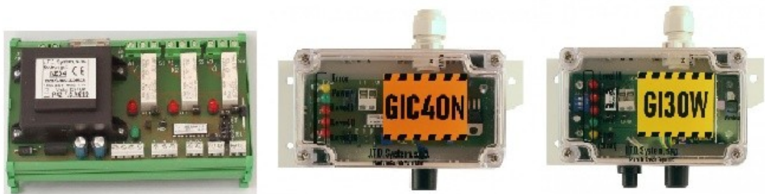
Obr. 31. Ústředna plynu včetně detektoru CO a výbušných plynů [vlastní]
