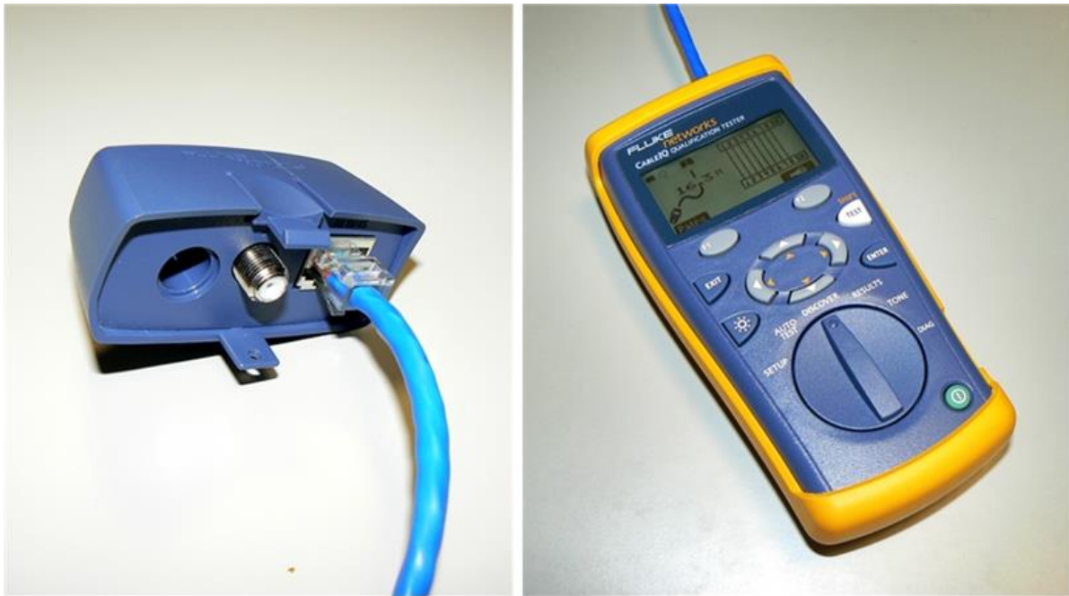
Obr. P8.3: Kontrola správného zapojení vodičů UTP kabelu
