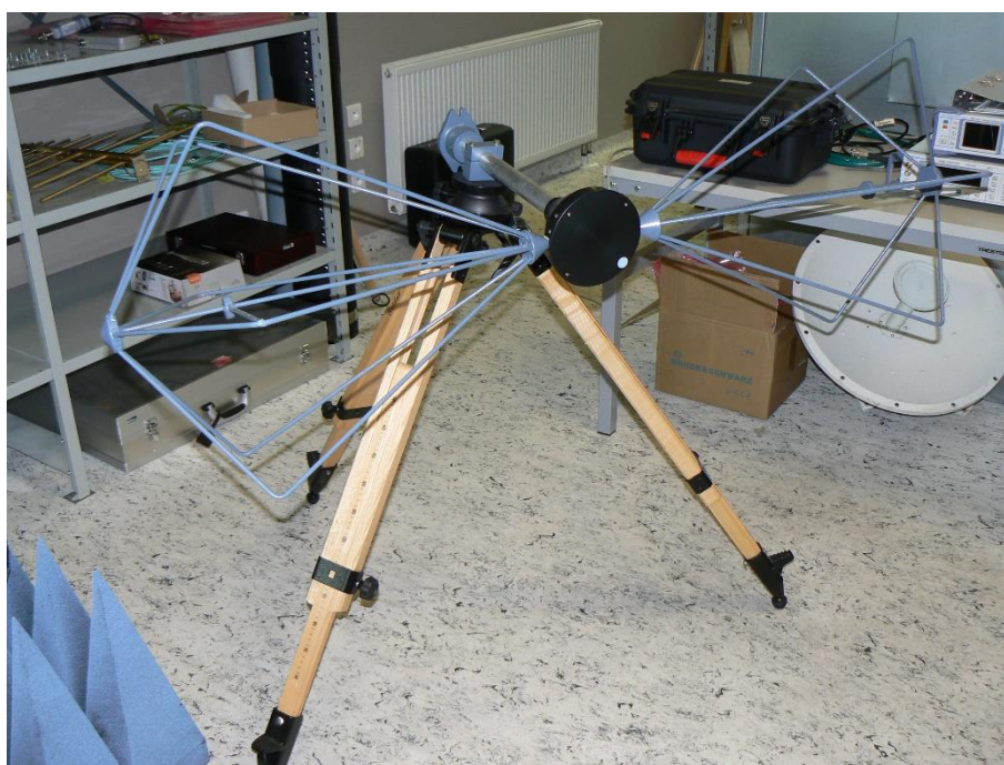
Obr. 4.21: Bikónická anténa - R&S HK116E
