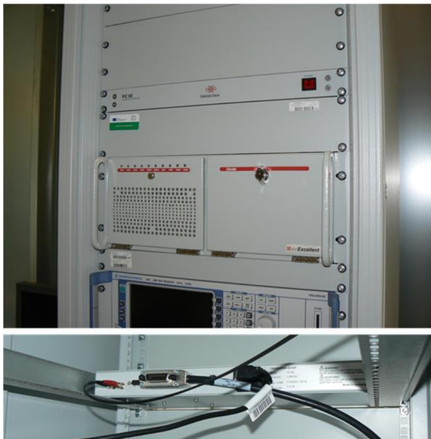
Obr. 4.10: Řídicí systém Frankonia - FC02
