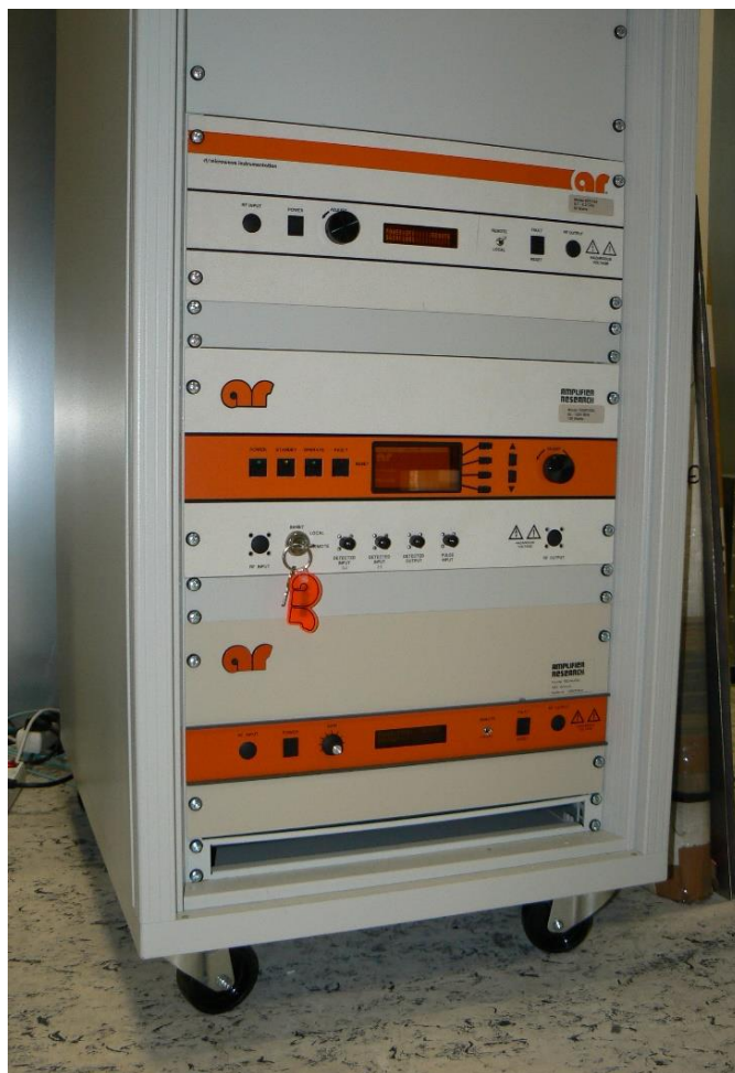
Obr. 4.20: Sada vysokofrekvenčních výkonových zesilovačů
