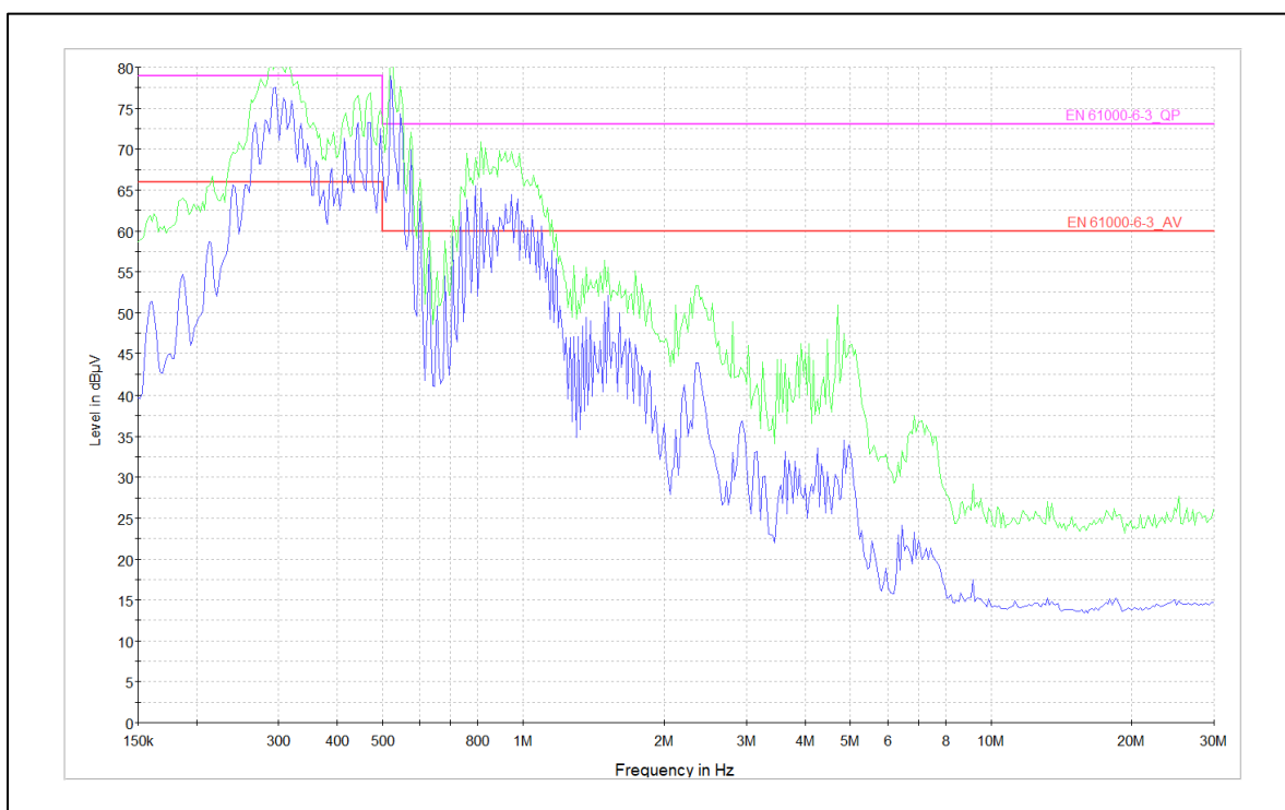
Obr. 7.11: Úroveň rušivého napětí šířeného po vodiči (-) při zatěžovacím proudu 0,5 A
