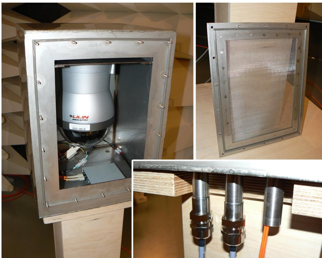
Obr. 11.1: Instalace kamerového systému do stínícího krytu SK – V1
