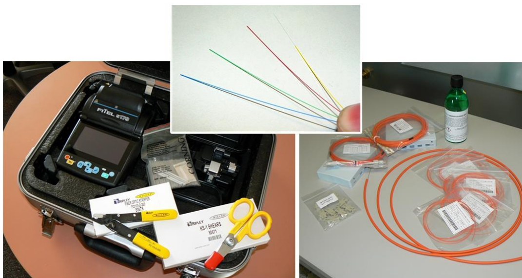
Obr. P7.1: Materiál pro vytvoření optické trasy a vybavení pro svařování
