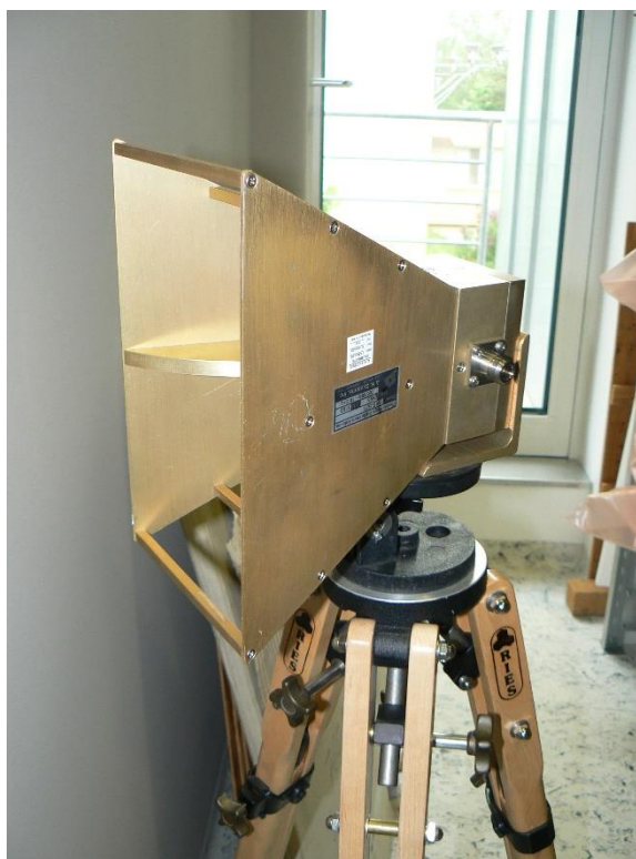
Obr. 4.19: Trychtýřová anténa - A.H. SYSTEMS SAS-571
