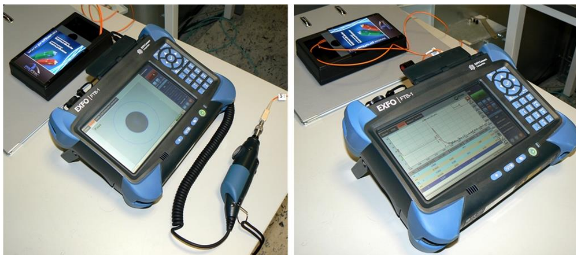
Obr. P7.9: Kontrola čistoty čela ferule, kontrola optické trasy
