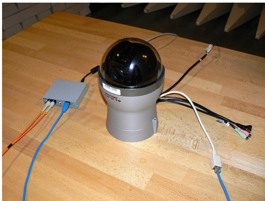
Obr. 10.1: Měření elektromagnetického rušení kamerového systému šířeného vyzařováním
