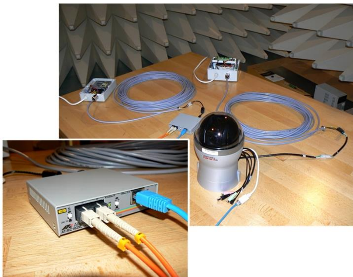
Obr. 9.2: Zkušební provoz kamery uvnitř bezodrazové stíněné komory
