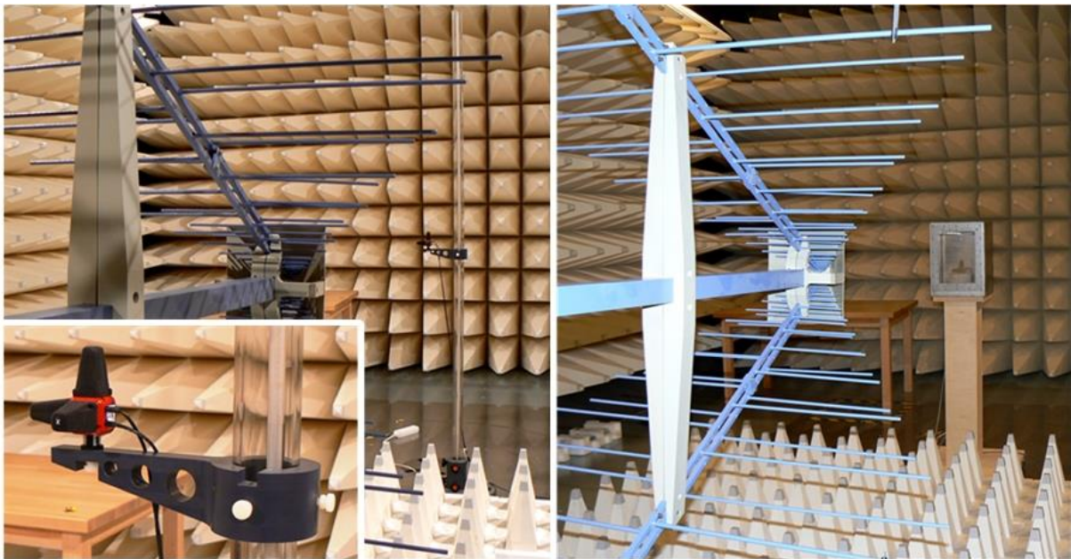
Obr. 13.1: Měření elektromagnetické stínící účinnosti krytu SK – V1
