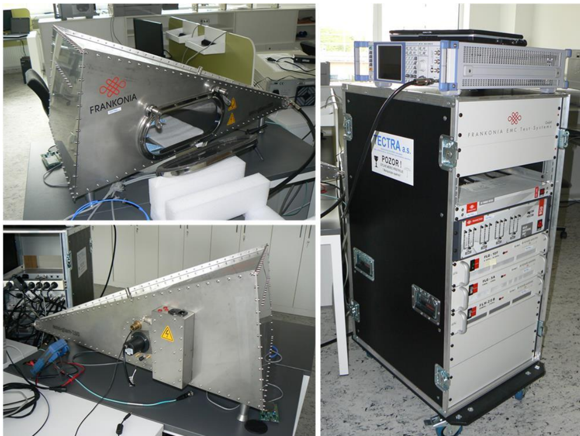
Obr. 4.24: GTEM komora – FRANKONIA 250 a skříň s přístrojovým vybavením
