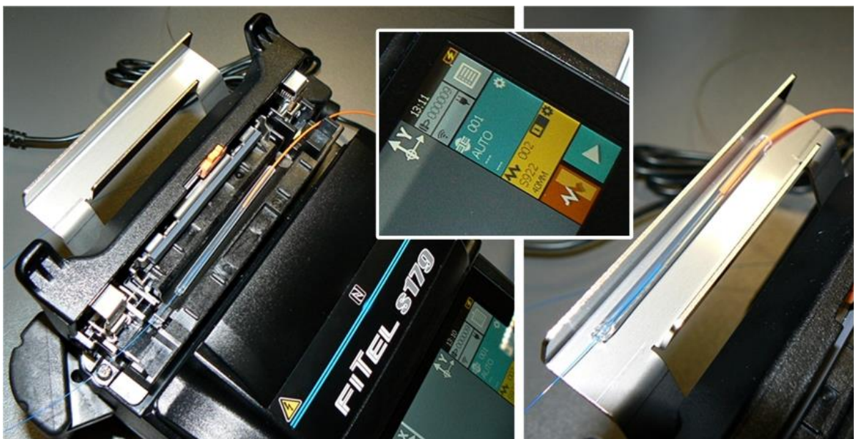
Obr. P7.5: Zatavení tepelně smrštitelné ochrany sváru
