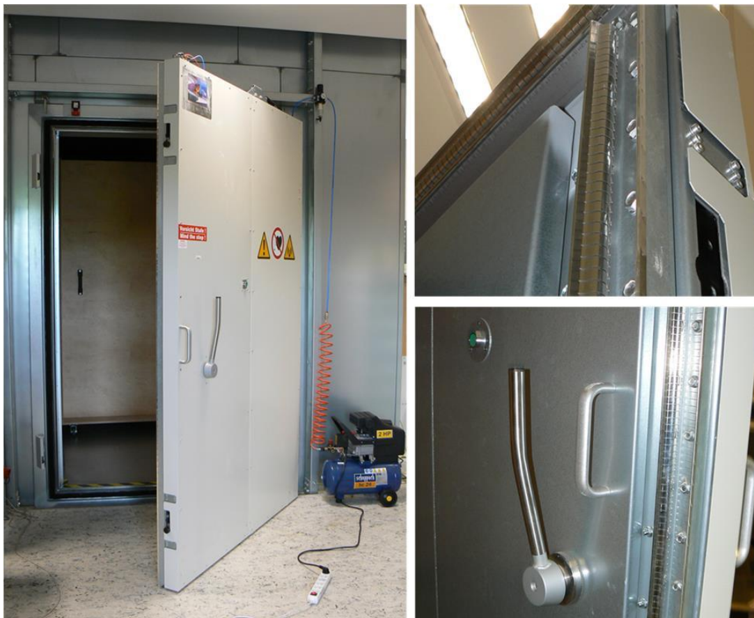
Obr. 4.4: Dveřní systém komory Frankonia SAC – 3 Plus S
