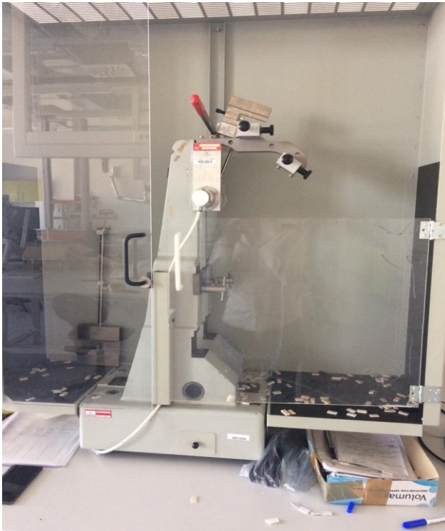
Obrázek 19 - Snímek přístroje rázové houževnatosti metodou Charpy
