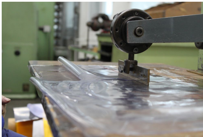
Obrázek 55 Ukázka svařování fólií mosaznou elektrodou
