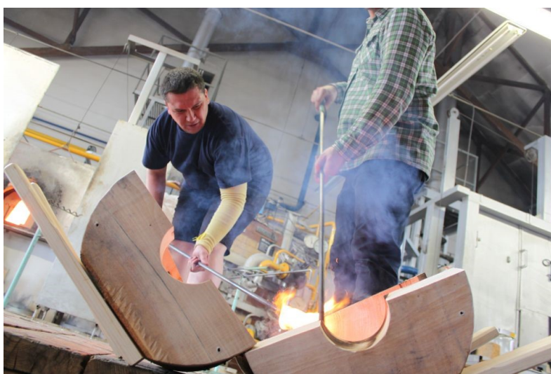
Obrázek 58 Příprava čerstvé bukové formy na první foukání
