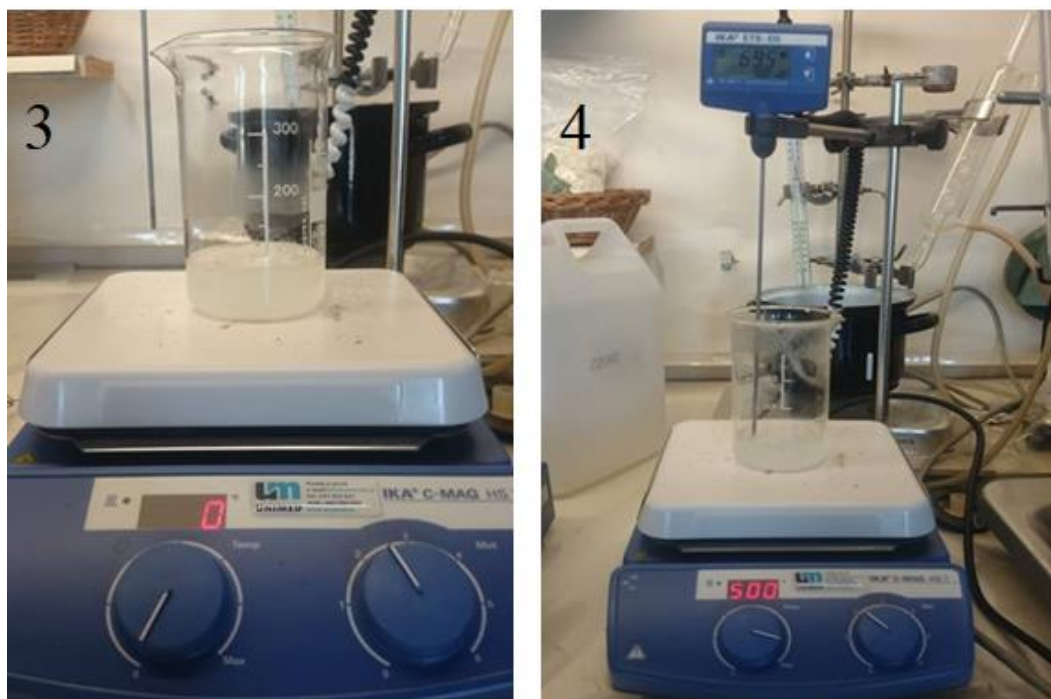
Obr. 16: Emulze voda – olej (3), Odpaření rozpouštědla (4)
