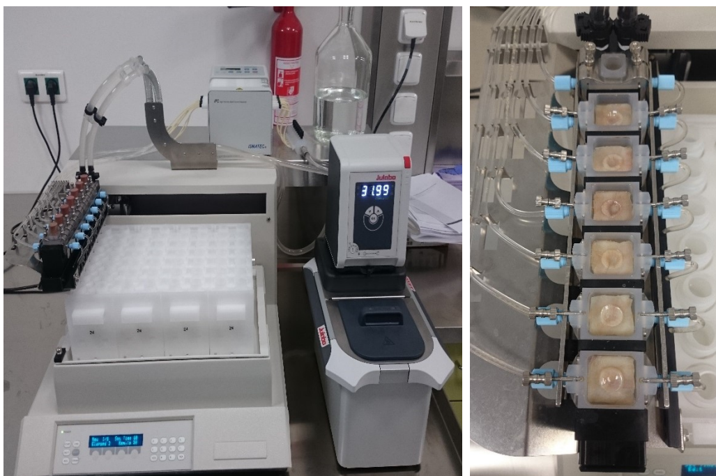
Obr. 7. Přístroj na měření transdermální absorpce (vlevo), detail na permeační cely s prasečí kůží a vloženými vzorky (vpravo).
