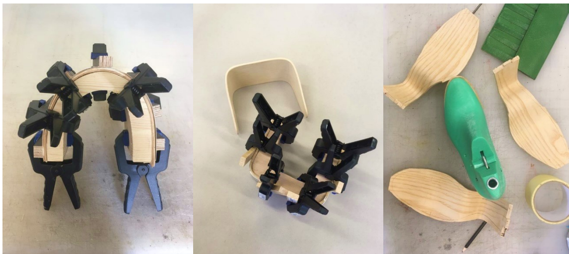
Obr. 48. Ohýbání kšiltu, výroba dílů kabelky, polotovary na podešve
