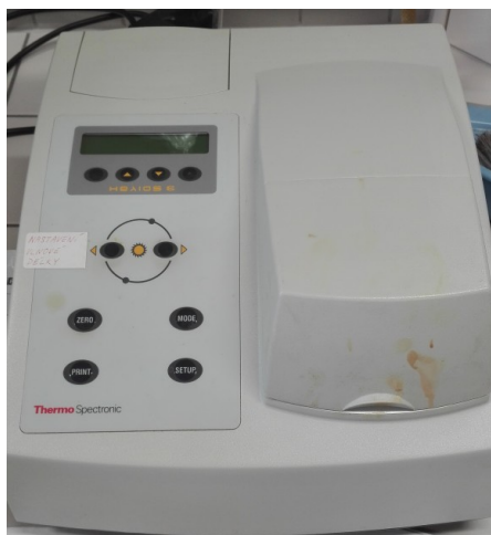
Obrázek 11: Spektrofotometr Helios – 3 pro měření transmittance (čirosti)
