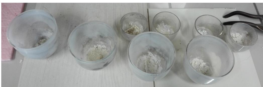
Obrázek 8: Vzorky želatin po spalování pro zjištění obsahu popelovin
