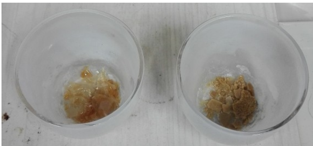
Obrázek 7: Vzorky želatin před spalování pro zjištění obsahu popelovin
