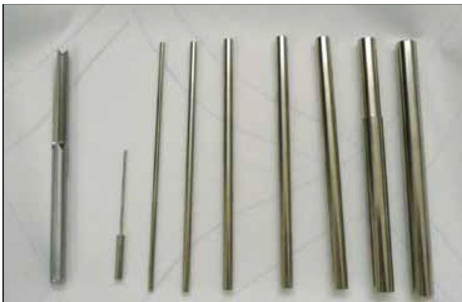
Obr. č. 8: Sondy pro penetrometrii [11]
