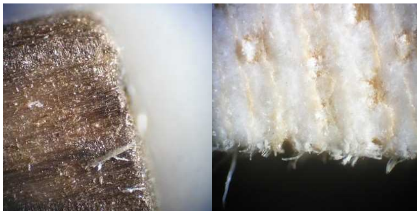
Obr. 41. Otřepy na hranách frézovaného vzorku
