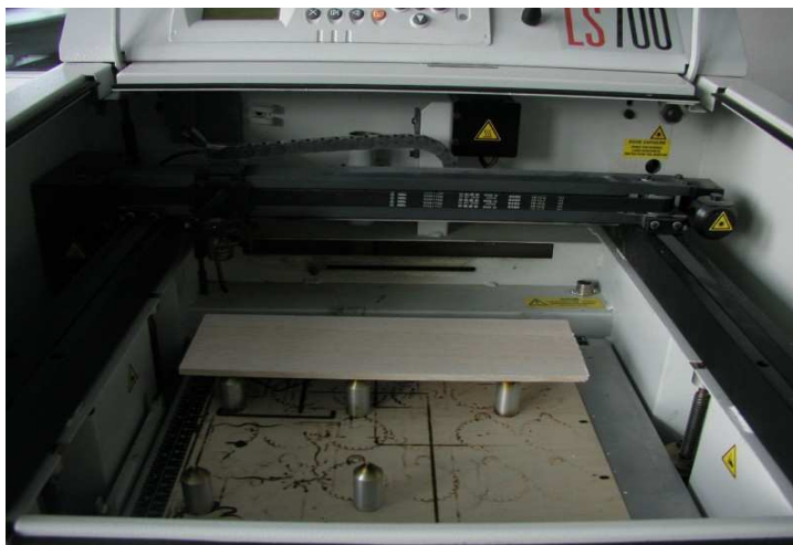
Obr. 31. Uložení balsového prkénka
