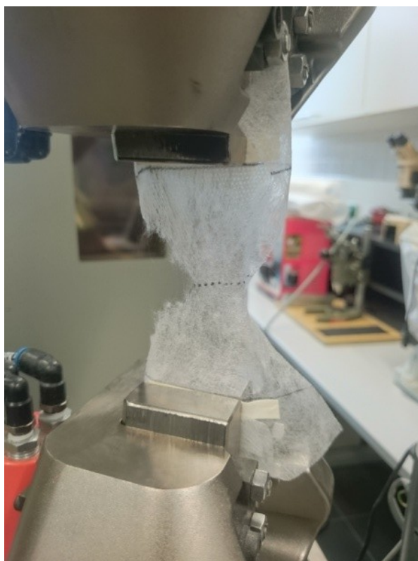
Obr. 23. Vzorek v průběhu dalšího trhání.
