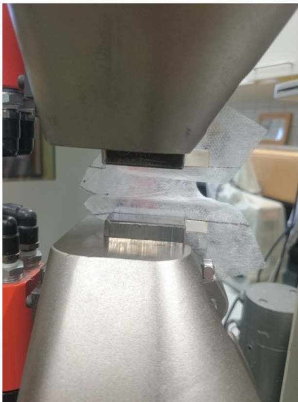
Obr. 22. Vzorek upnutý podél nerovnoměrných stran lichoběžníku.
