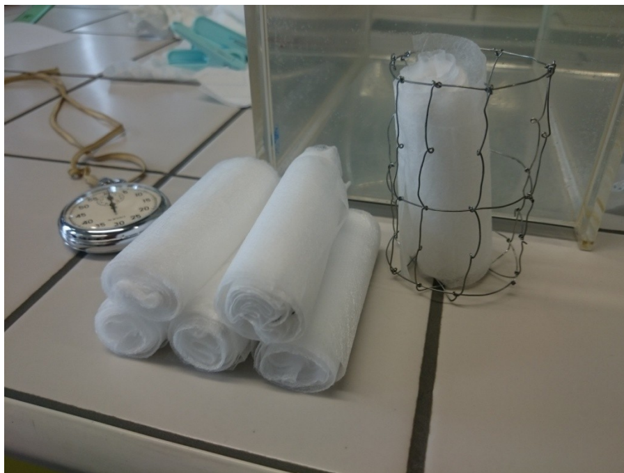
Obr. 30. Připravené vzorky s košíkem pro zjištění doby absorpce kapalin.
