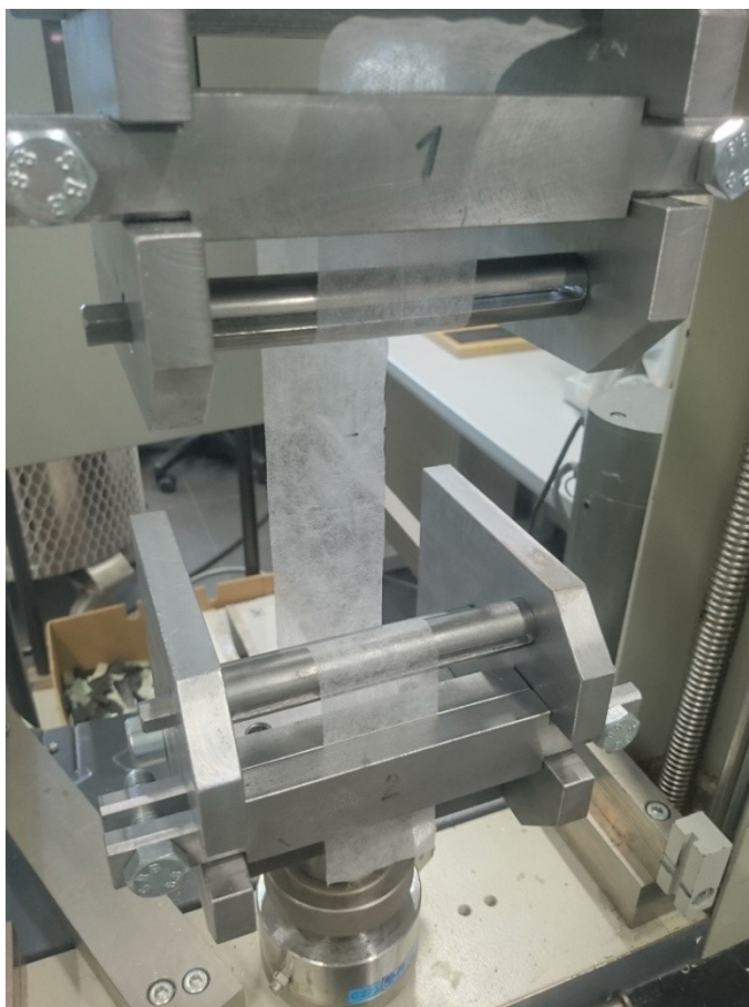
Obr. 17. Vzorek upnutý v čelistech pro testování textilních materiálů.
