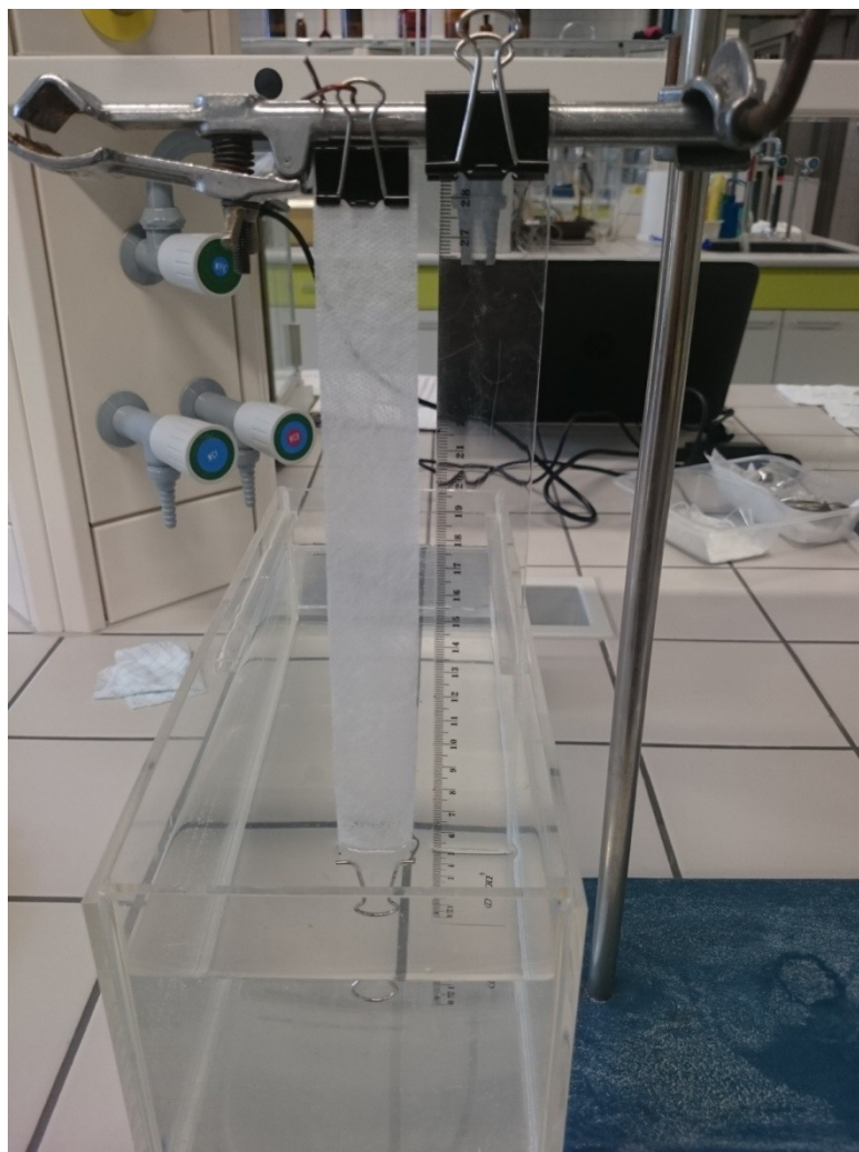
Obr. 33. Upnutý vzorek při zkoušce knotového efektu.
