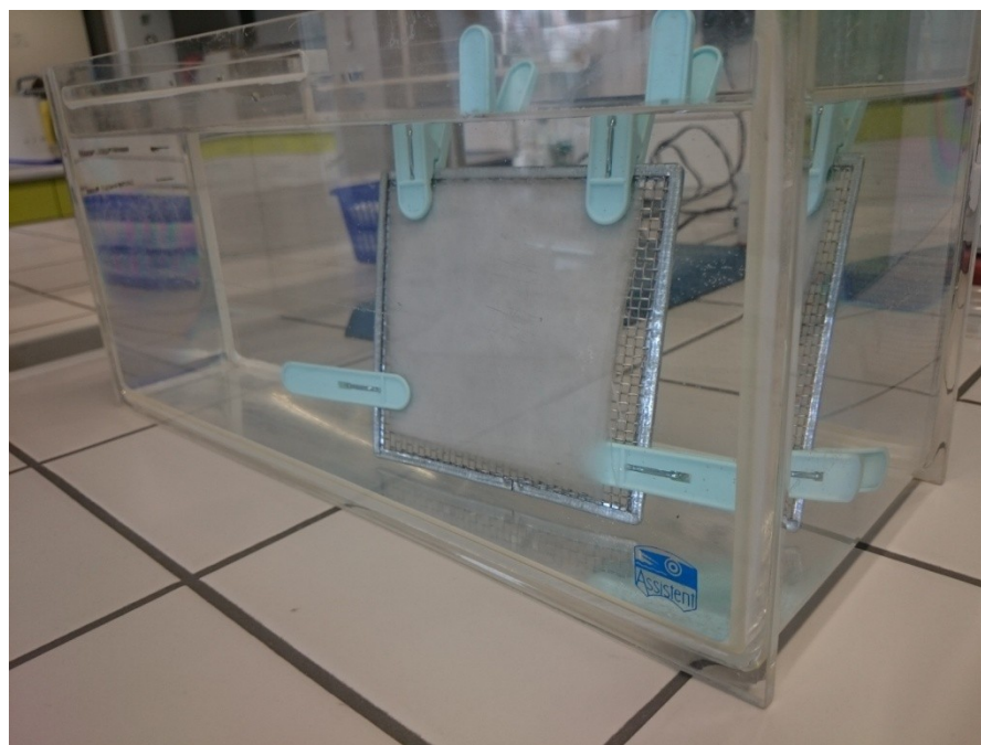
Obr. 31. Smáčení vzorku při zkoušce absorpce kapalin.
