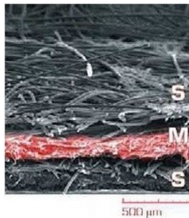
Obr. 13. Průřez textilií s kombinací SMS. [22]
