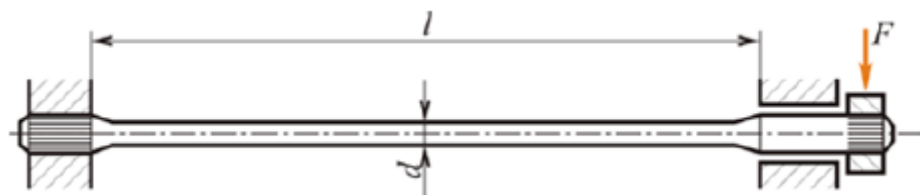
Obr. 45. Torzní (zkrutná) tyč [17]
