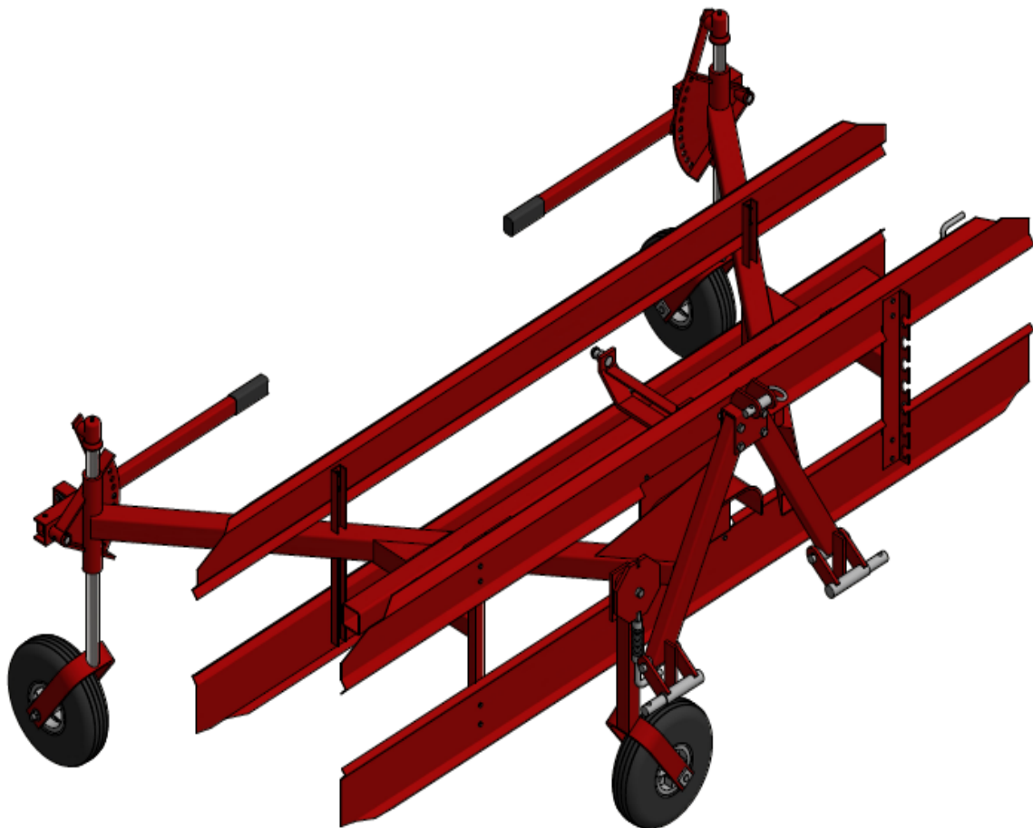
Obr. 51. Rám obraceče s navařenými celky
