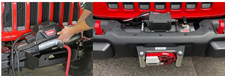
Obr. 21. Stálé uchycení navijáku. [29]
