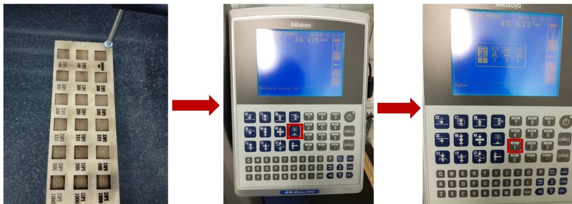
Obr. 9.2 Postup nastavení nulového bodu.
