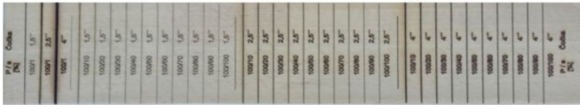
Obr. 8.11 Vzorky řezů vytvořené při změně rezné rychlosti a ohniskové vzdálenosti.
