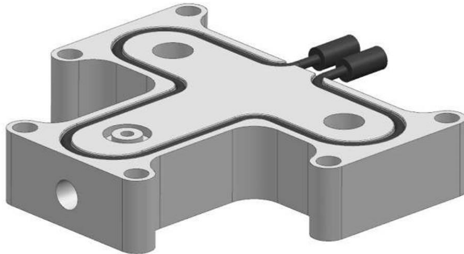
Obr. 19. Rozvodový blok tvaru T [12]
