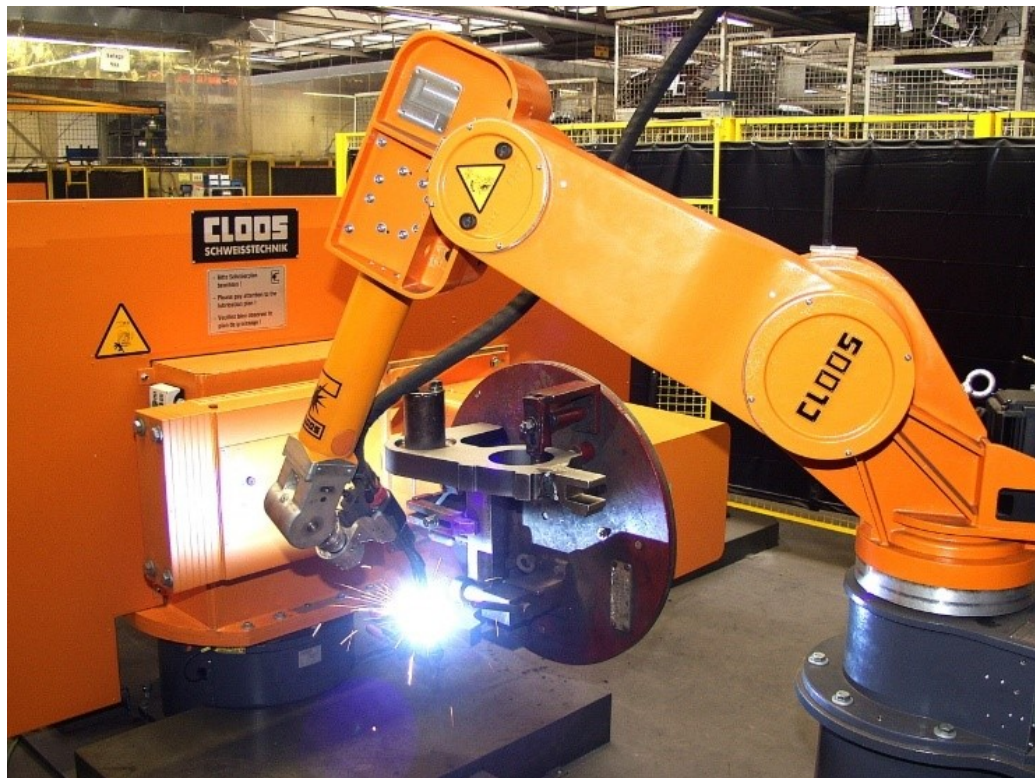
Obr. 11 Koncový efektor technologický – svařování [8]
