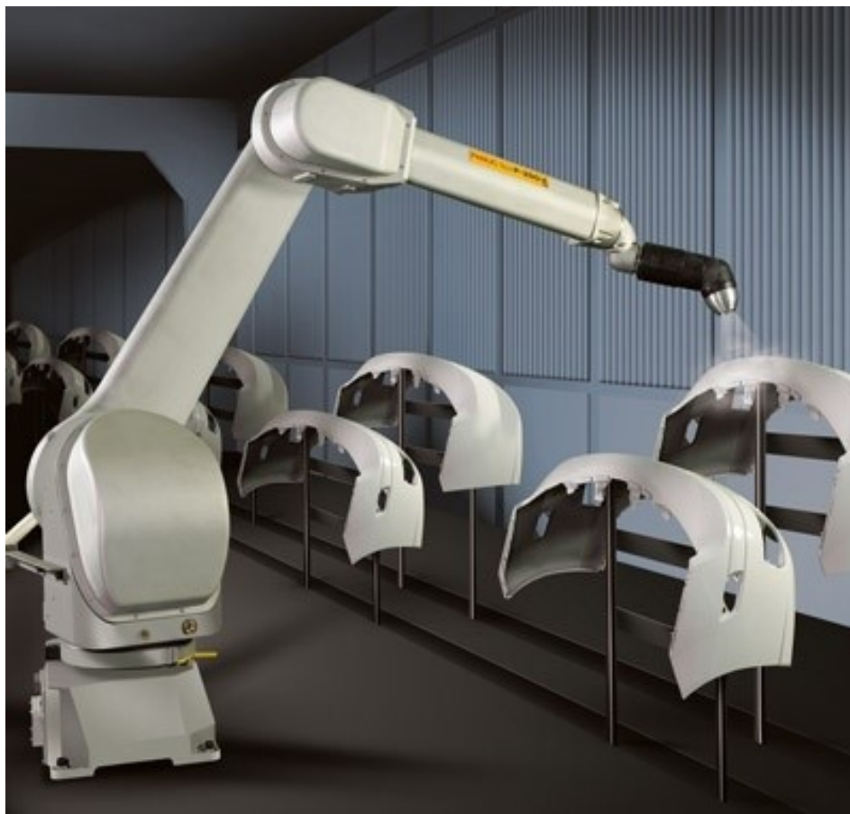
Obr. 10 Koncový efektor technologický – lakování [30]
