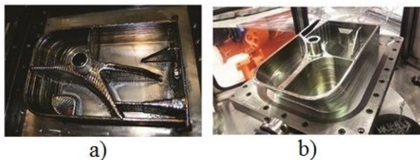
Obr. 22. Porovnání metody WAAM (a) s obráběním (b) [29]
