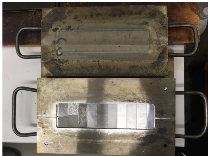
Obr. 46. Vulkanizační forma se zkušebními tělisky
