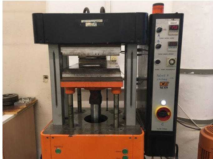
Obr. 45. Hydraulický vulkanizační lis IGTT
