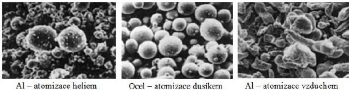
Obr. 24. Tvar a struktura částic po atomizaci plynem [33]
