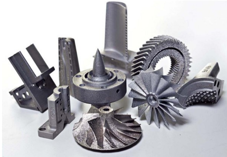
Obr. 14. Produkty vyrobené metodou SLS [12]
