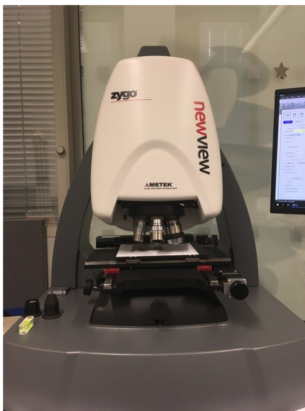
Obr. 37. Optický měřicí přístroj NewView 8000
