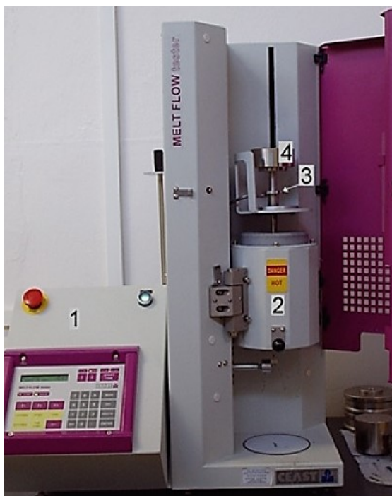
Obr. 21. Výtlačný plastometr 1) řídicí panel 2) válec; 3) píst; 4) závaží [13]
