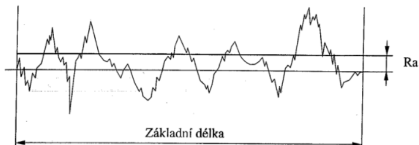
Obr. 15 Aritmetická úchylka posuzovaného profilu [10]
