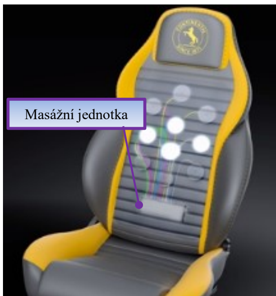
Obr. 12. Masážní jednotka v pneumatickém systému sedadla [22]
