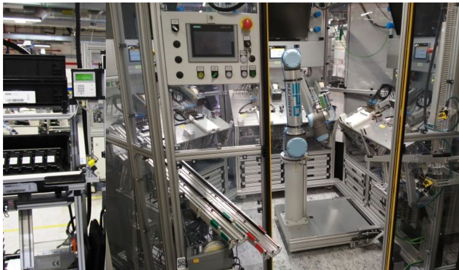
Obr. 37. Final test s robotem a optickou bránou po optimalizaci
