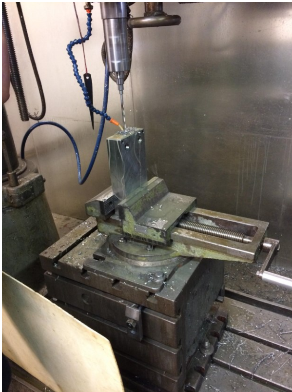
Obr. 76 Vrtání chladicího systému
