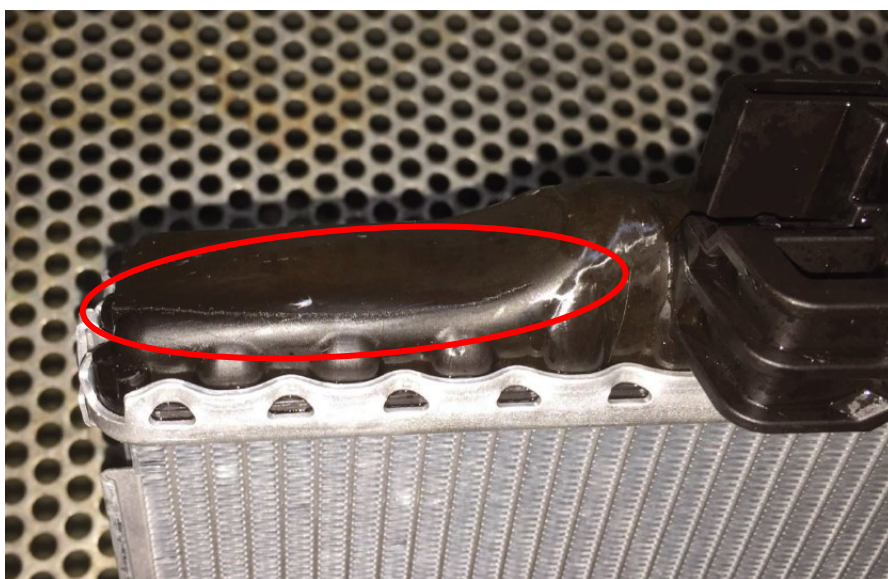
Obr. 51. Detail praskliny na vzorku č. 7
