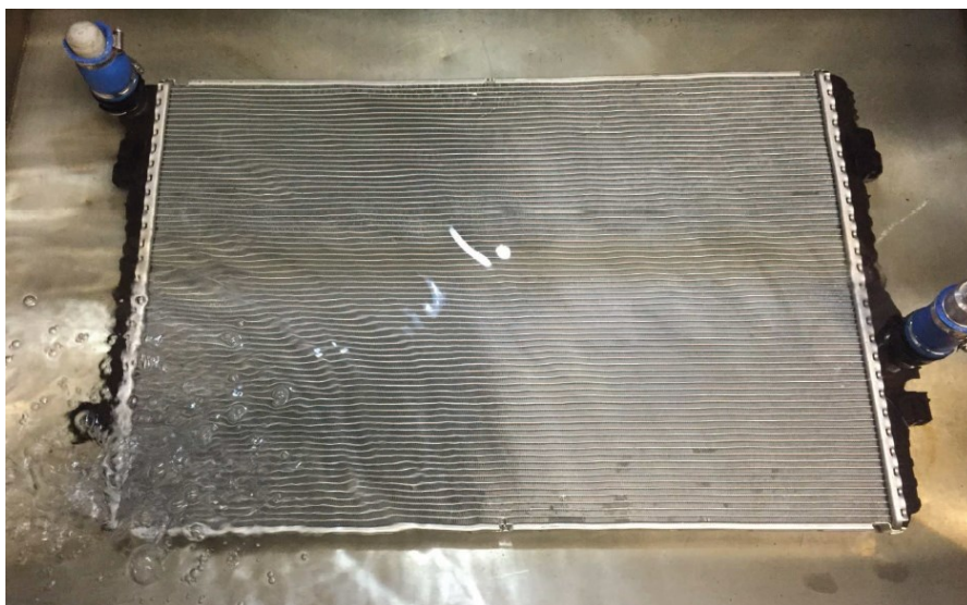
Obr. 50. Únik vzorku č. 7 při testu těsnosti
