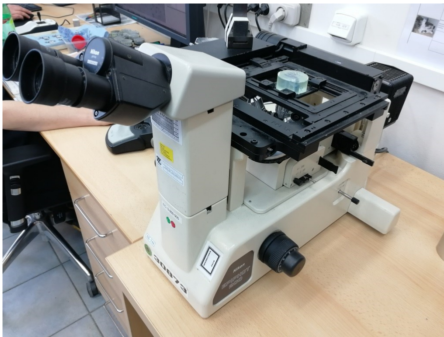
Obr. 44. Mikroskop Nikon Epiphot 200
