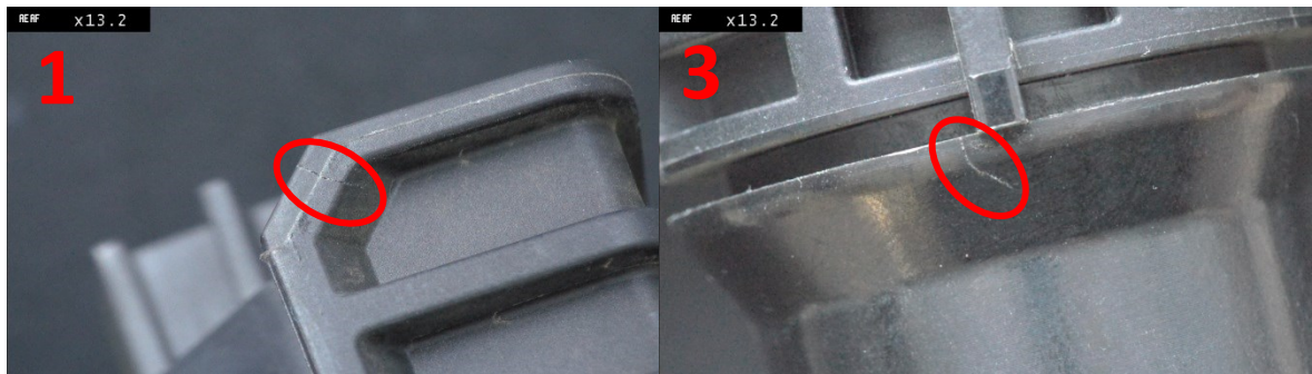
Obr. 30. Trhliny 1 a 3 po „Cooking“ testu
