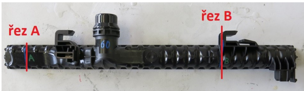
Obr. 43. Místa a označení řezů k měření pórovitosti
