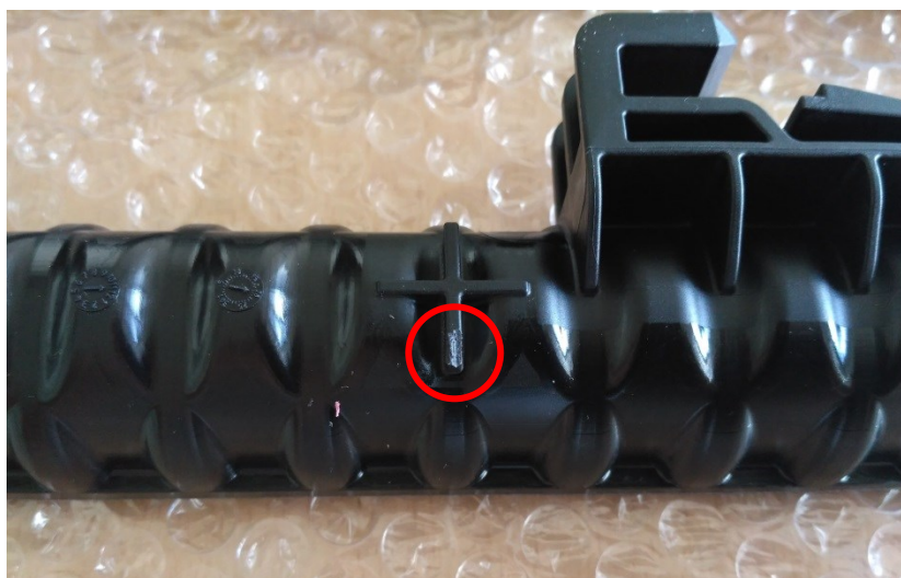
Obr. 37. Místo odebrání vzorků pro DSC analýzu
