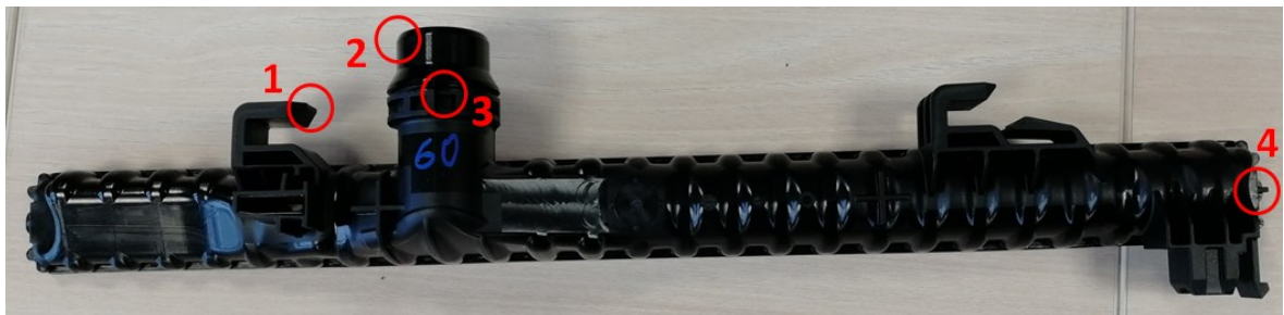
Obr. 29. Místa nálezu trhlin na komoře po Cooking testu
