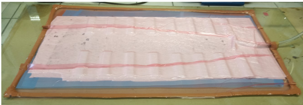
Obrázek 25. Deska při procesu s vytvrzování
