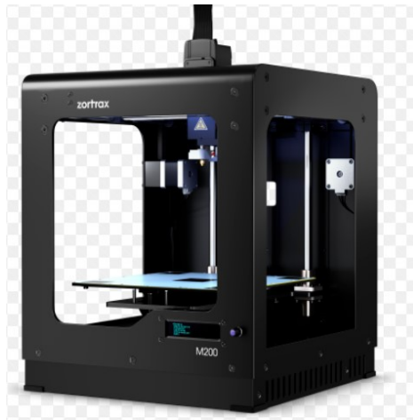
Obrázek 20. 3D tiskárna Zortrax M200 [15]
