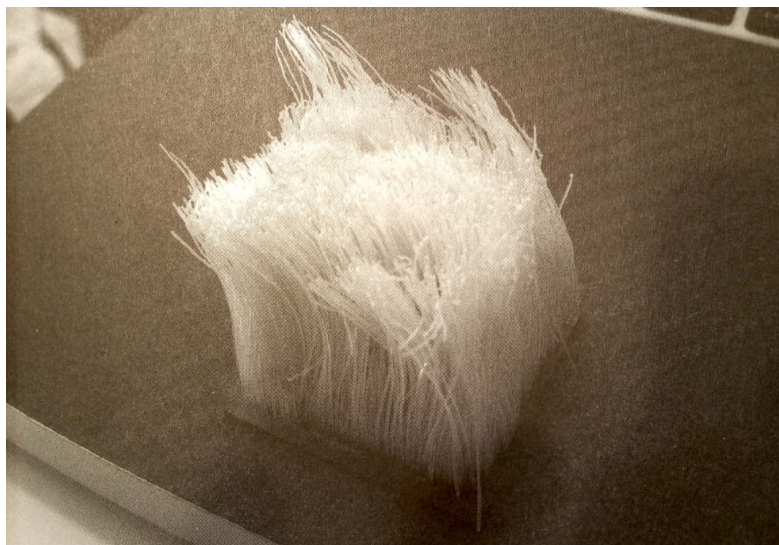
Obrázek 17. Vlasová struktura vytisknutá na 3D tiskárně Ember [5]
