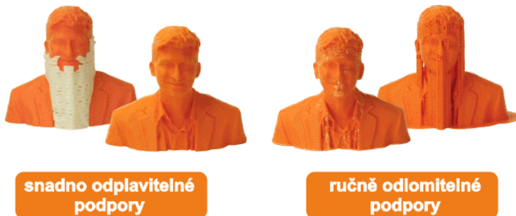
Obr. 27 Srovnání rozpustných a mechanicky odstranitelných podpor [27]
