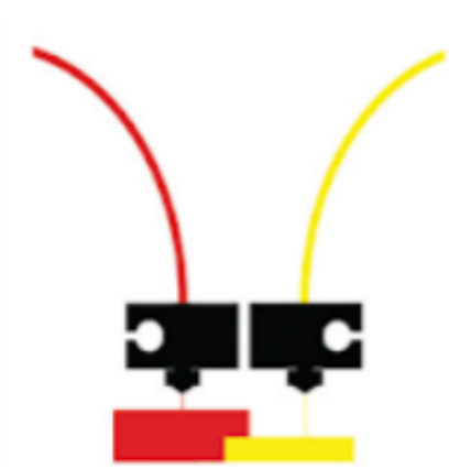
Obr. 38 Princip vytlačovací hlavy Chimera [37]
