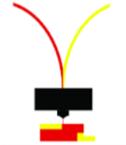
Obr. 40 Princip vytlačovací hlavy Cyclop [38]
