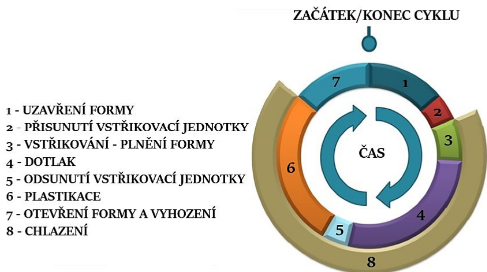
Obr. 1 Vstřikovací cyklus v čase [3]
