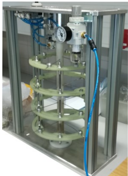
Obr. 88 Cyklické zatěžování externího fixátoru
