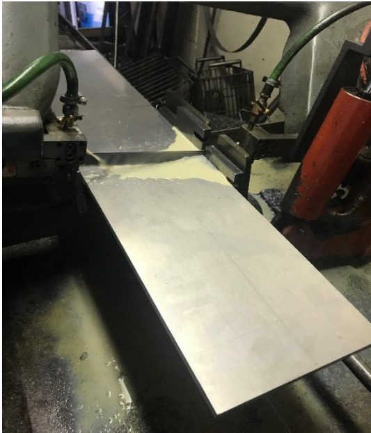
Obr. 55 Řezání základových desek
