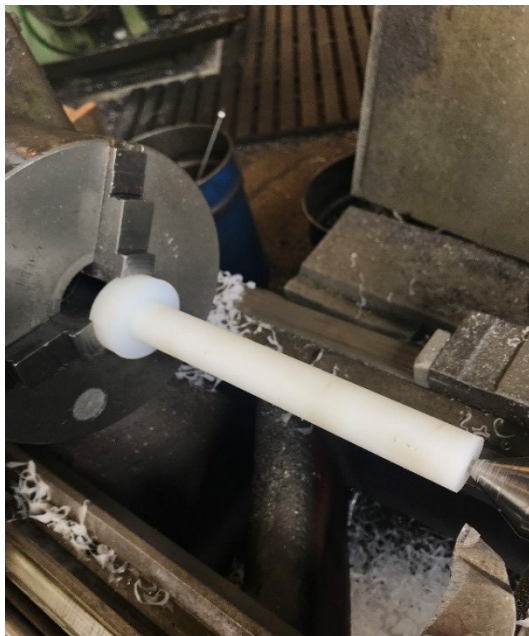
Obr. 57 Soustružení spodní základny
