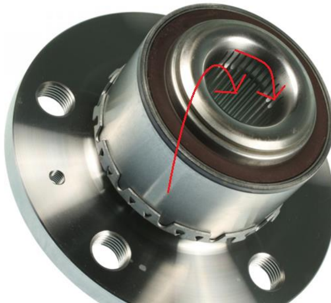
Obrázok 14 Náčrt hornej časti ložiska, ktorá sa sústruží (vnútro a vonkajšie hrany)
