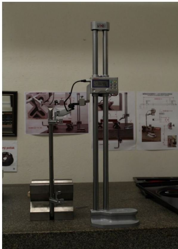
Obrázek 13 Výškoměr používaný k měření (Interní materiály)
