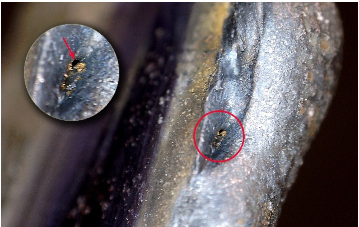
Obrázek 12 Špatně svařené plynové vedení – uchází (vlastní zpracování)
