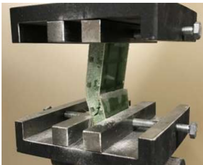
Obr. 59 Tlaková zkouška za působení bočního tlaku
