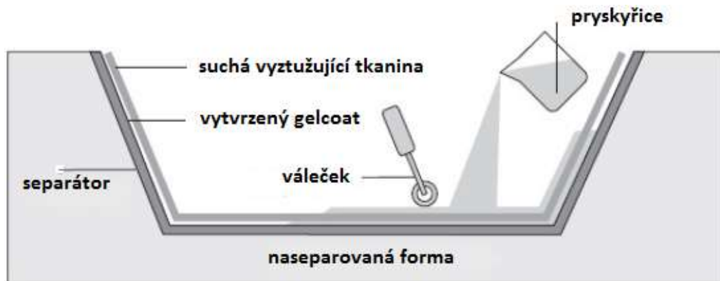
Obr. 15 Ruční kladení [24]
