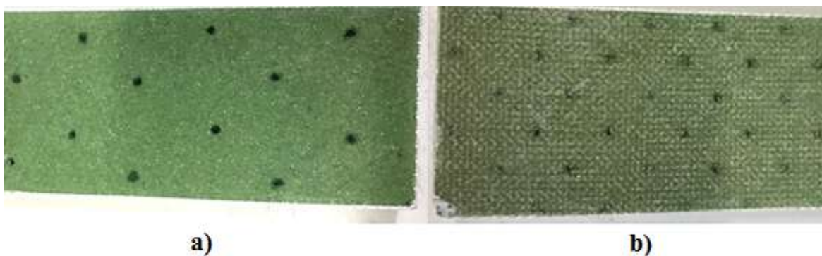
Obr. 51 Nedokonalé prosycení sendvičové konstrukce: a) dokonalé prosycení, b) nedokonalé prosycení
