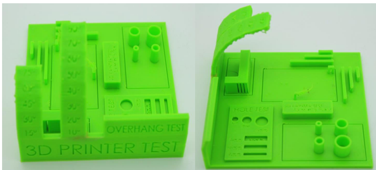
Obrázek 51: Fotografie kompletního 3D tiskařského testu pro vizuální posouzení kvality tisku z ABS při tisku nižší rychlosti.
