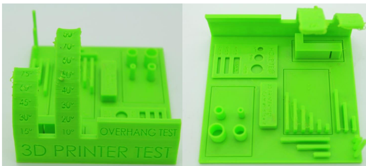
Obrázek 52: Fotografie kompletního 3D tiskařského testu pro vizuální posouzení kvality tisku z ABS při tisku vyšší rychlosti.
