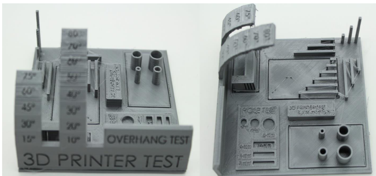
Obrázek 50: Fotografie kompletního 3D tiskařského testu pro vizuální posouzení kvality tisku z PLA při tisku vyšší rychlosti.
