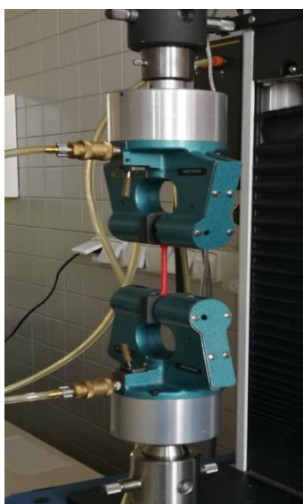
Obrázek 57: Detail uchycení vzorku v čelistech trhacího stroje během tahové zkoušky.
