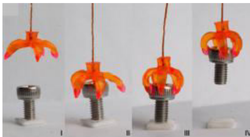
Obrázek 23: Postupná tvarová změna proces chapadla vlivem změny teploty [45].
