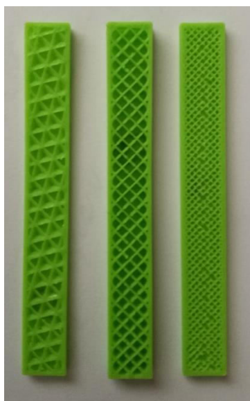
Obrázek 59: Typy výplní (vlevo: cubic, uprostřed: grid a vpravo: lines).
