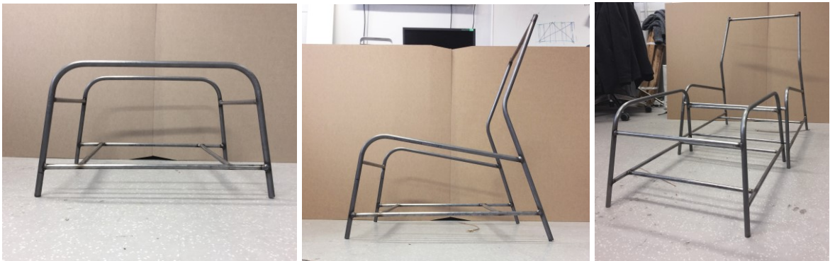
Obr. 36, 37, 38: Zvarené konštrukcie (vľavo sedák, v strede kreslo, vpravo kompletný set)
