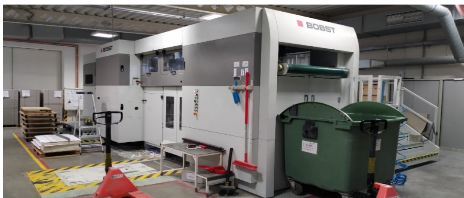
Obrázok 17 Výsekový stroj Bobst Novacut 108 ER (vlastné spracovanie)
