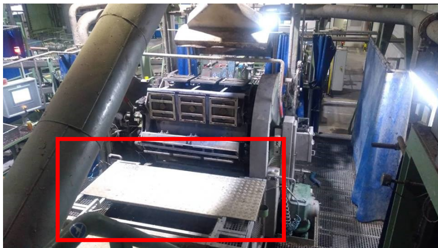
Obrázek 37 Lávka, na které stojí formaři (vlastní zpracování)
