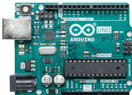
Obrázek 9: Arduino Uno r.3
