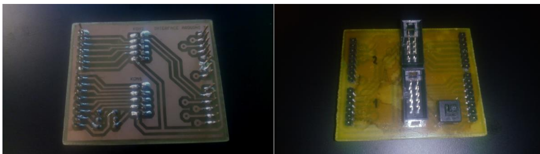
Obrázek 14: SPŠ Shield + jeho zapojení pinů(zadní strana)
