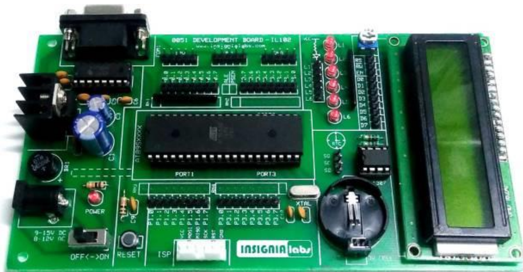
Obrázek 3: Mikroprocesor 8051 (uprostřed) a jeho vývojová deska.
